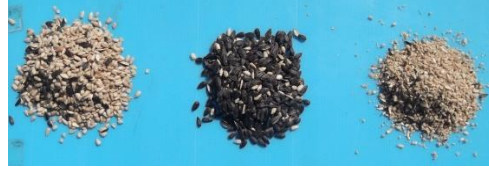
ก. การทดลองกะเทาะเมล็ดทานตะวันด้วยเครื่องต้นแบบ
