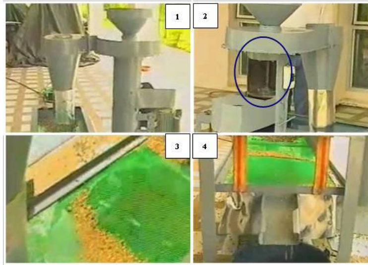
ภาพที่ 2 ภาพแสดงเครื่องกะเทาะเมล็ดทานตะวันระดับอุตสาหกรรมขนาดเล็ก (1) แสดงส่วนบนของเครื่อง: เครื่องกะเทาะระบบแรงเหวี่ยงแบบทรงกำลัง (2) ชุดใบพัดตีเมล็ด (ในวงกลม) (3) ไซโคลนตักฝุ่น) ที่มา: http://www.tototo.page.ti ไรต์ตันเจริญ ข้อมูลเมื่อ 4 กรกฎาคม 2555
