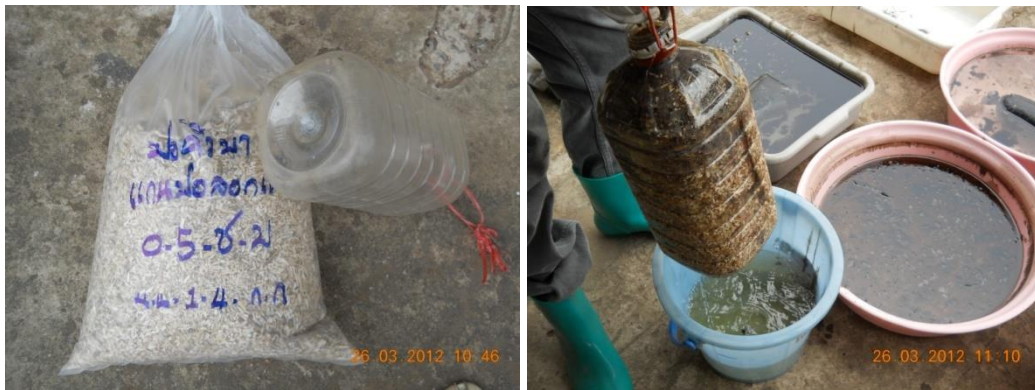
การใช้แกนปอกรองคราบน้ำมันในน้ำทำให้น้ำสะอาดขึ้น
