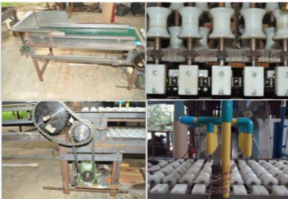
รูปที่ 23 ดำเนินการสร้างเครื่องต้นแบบเป่าน้ำใต้ก๊ลิบเลี้ยงมังคุด
