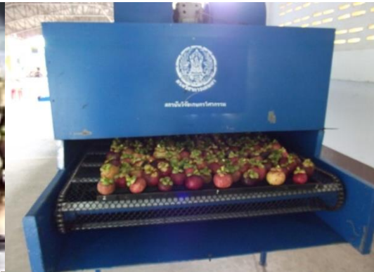
รูปที่ 5 เป่าแห้งมังคุดสดด้วยเครื่องต้นแบบ
