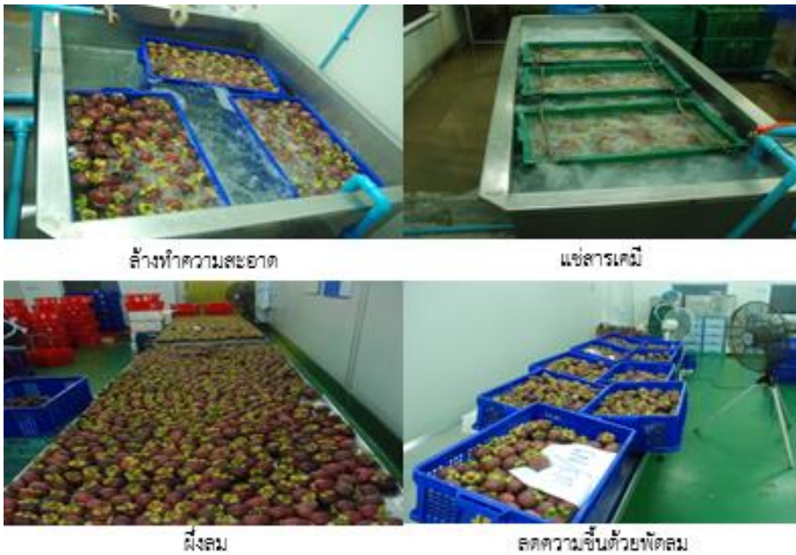
รูปที่ 1. กระบวนการในโรงคัดบรรจุ
