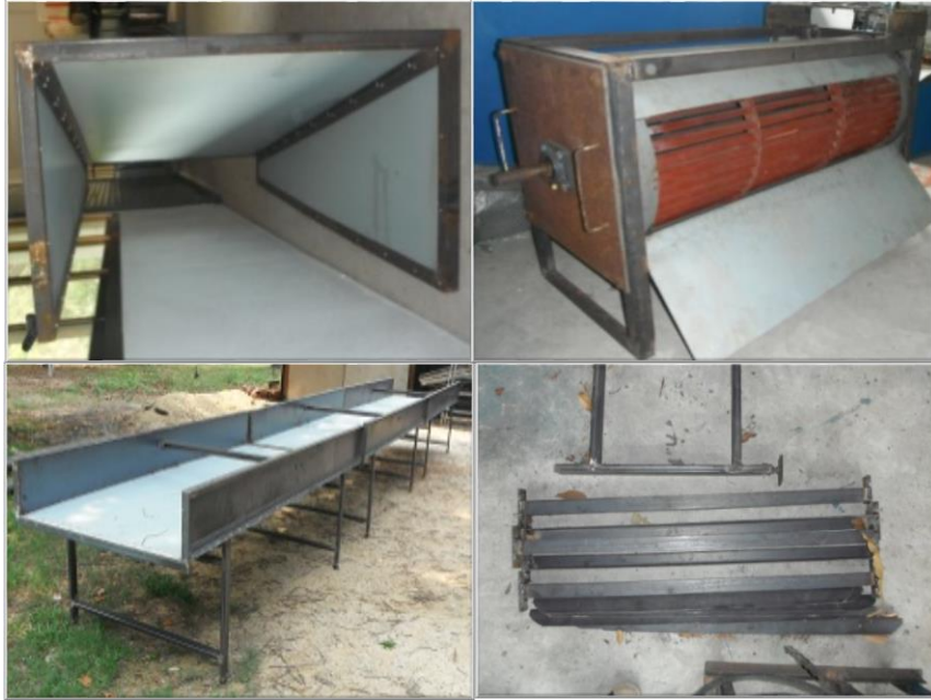
รูปที่ 20 ดำเนินการสร้างเครื่องต้นแบบเป่าแห้งมังคุดสดแบบอุโมงค์ลม
