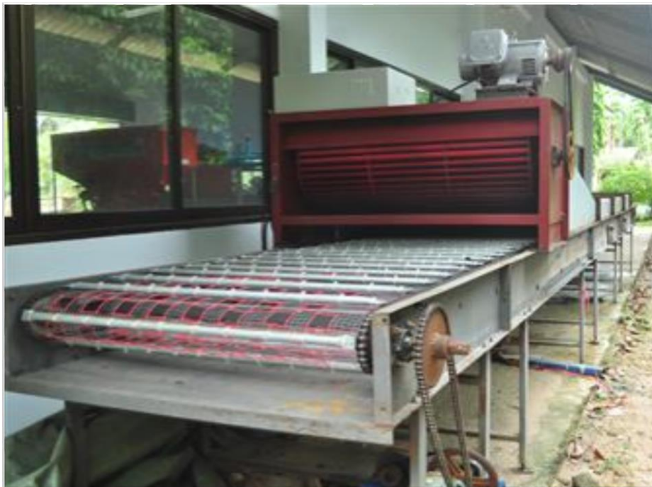
รูปที่ 20 ดำเนินการสร้างเครื่องต้นแบบเป่าแห้งมังคุดสดแบบอุโมงค์ลม
