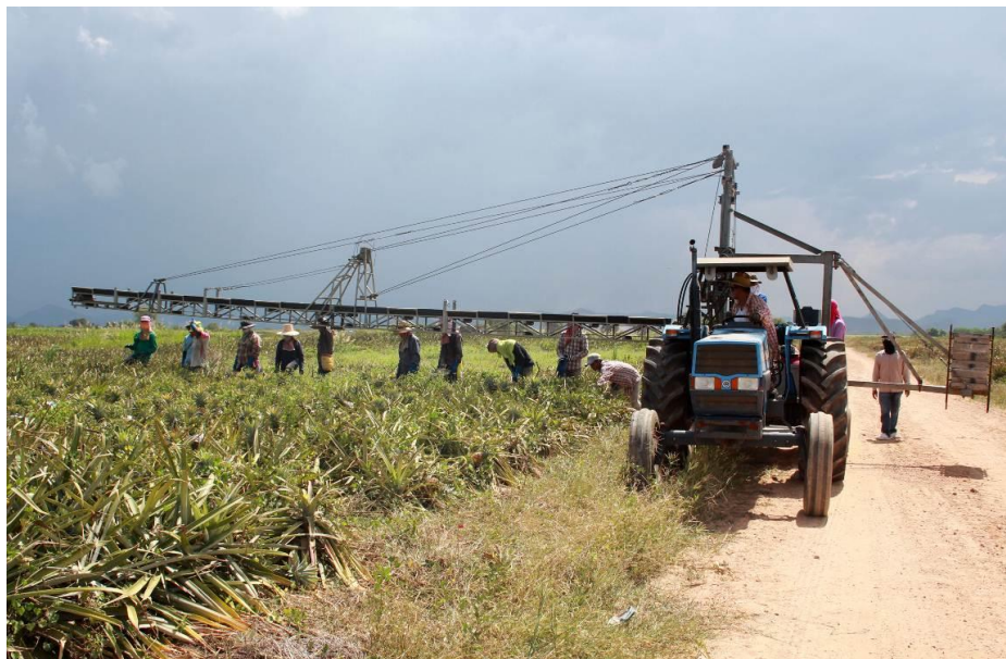
รูปที่ 14 เครื่องลำเลียงผลสับปะรดขณะทำงานในแปลงสับปะรดแบบโรงงาน (ด้านหน้า)
