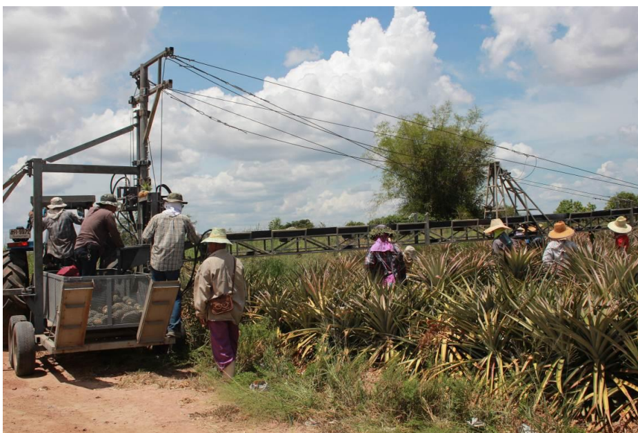
รูปที่ 15 เครื่องลำเลียงผลสับปะรดขณะทำงานในแปลงสับปะรดแบบโรงงาน (ด้านหลัง)
