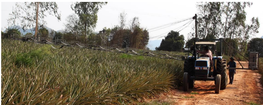
รูปที่ 12 เครื่องลำเลียงผลสับประดขณะทำงานบนพื้นที่เนินเขา
