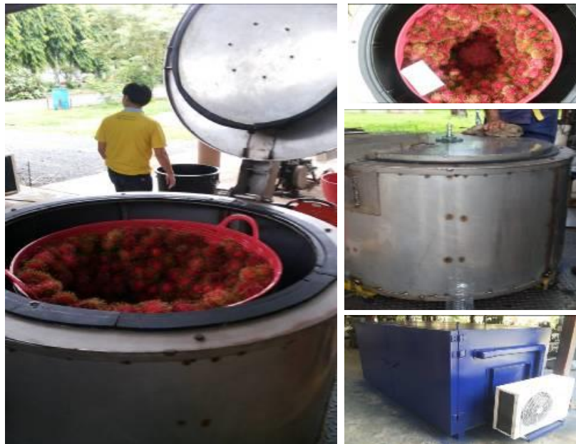
รูปที่ 5 เครื่องต้นแบบเครื่องลดความชื้นเงาะสดแห้งด้วยแรงเหวี่ยงสไลด์น้ำออกจากผลเงาะ ขนาดถังปั่น 50 กิโลกรัม (ความสามารถของเครื่อง 4,800 กิโลกรัม/วัน)
