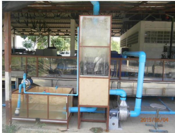
ภาพที่ 2 หอบำบัดก๊าซ SO 2 โดยใช้หลักการเกี่ยวกับหอบำบัดก๊าซ SO 2 ของโรงใช้โซดาไฟในการดักจับปนผอยผ่านชั้นมีเดียที่หนา 50 ซม.
