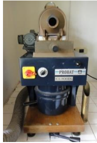
เครื่องคั่วยี่ห้อ PROBAT รุ่น PRE-1 ELECTRIC ROASTER (พลังงานไฟฟ้า)
