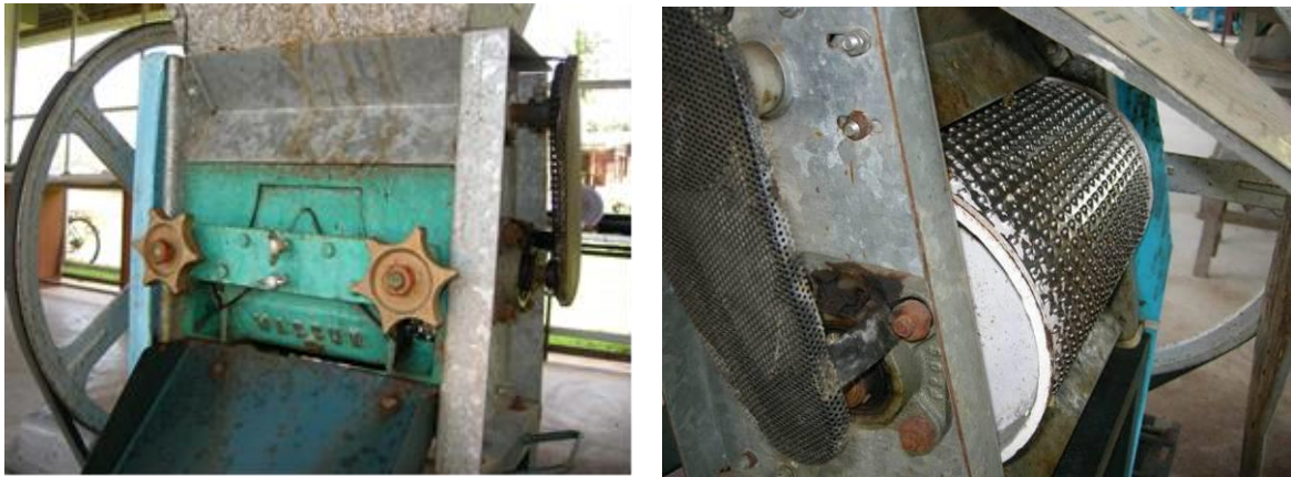
รูปที่ 7 เครื่องสีเปลือกสตกาแฟแบบทรงกระบอกแนวนอนผลิตในประเทศ
