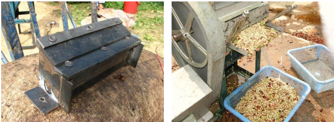
รูปที่ 17 ทดสอบชุดควบคุมการลอกเปลือกแบบแผ่นยางที่ศูนย์วิจัยและพัฒนาการเกษตรที่สูงเชียงราย
