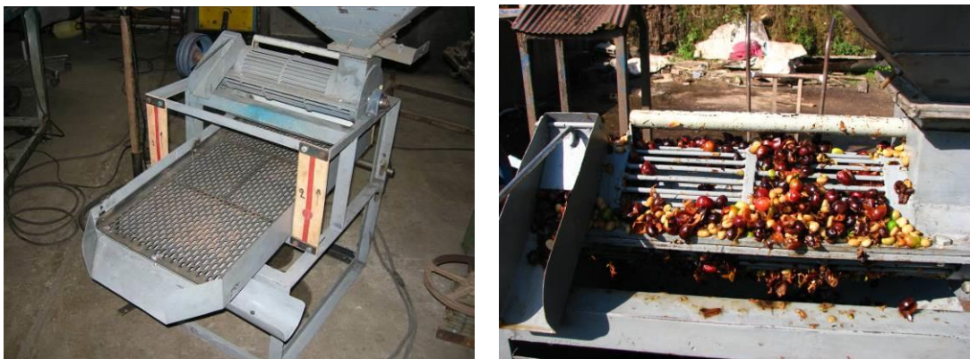
รูปที่ 15 ต้นแบบเครื่องลอกเปลือกกาแฟผลสดแบบแกนทรงกระบอกแนวนอนติดรีวพร้อมตะแกรงโยก
