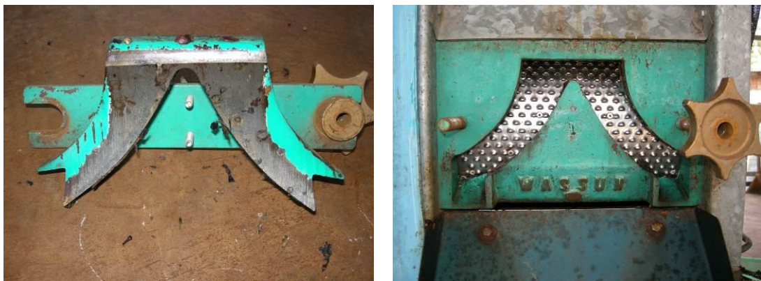
รูปที่ 8 เครื่องลอกเปลือกกาแฟผลสด แบบมีส่วนปรับการสีและส่วนปรับการแยกเปลือกแยกกัน
