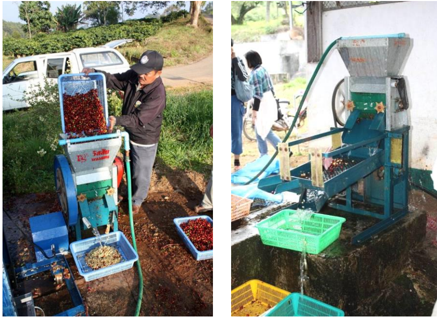
รูปที่ 10 เครื่องลอกเปลือกกาแฟ มีตะแกรงโยกคัดแยกเปลือกและผลกาแฟที่ลอกเปลือกไม่สมบูรณ์ (ขวา)
