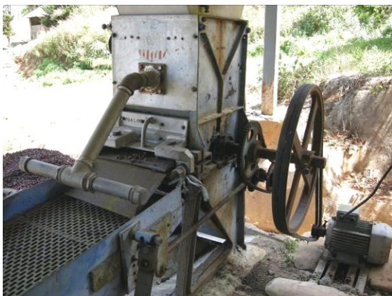
รูปที่ 12 เครื่องลอกเปลือกกาแฟผลสด มีชุดควบคุมการลอกเปลือกแบบแผ่นยาง
