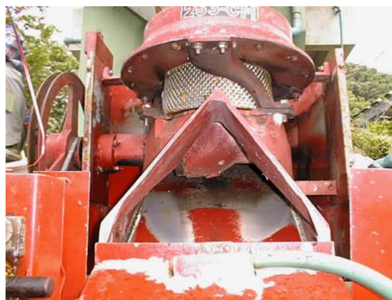
รูปที่ 11 เครื่องสีเปลือกสดกาแฟแบบลูกสีทรงกรวยตัดแนวตั้ง
