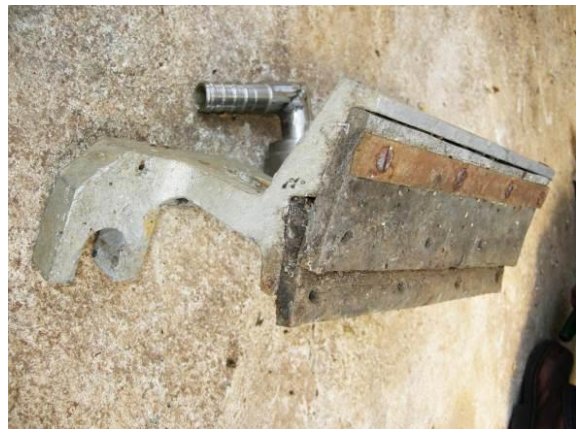
รูปที่ 12 เครื่องลอกเปลือกกาแฟผลสด มีชุดควบคุมการลอกเปลือกแบบแผ่นยาง
