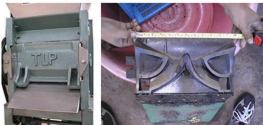
รูปที่ 9 เครื่องลอกเปลือกกาแฟผลสด แบบมีส่วนปรับการสีและส่วนปรับการแยกเปลือกเป็นชิ้นเดียวกัน
