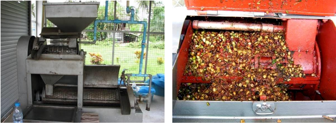
รูปที่ 13 เครื่องลอกเปลือกและตัดเมื่ออกกาแฟ (Le Trung Chau) และผลผลิตที่ได้จากการสีกาแฟโรบัสต้า
