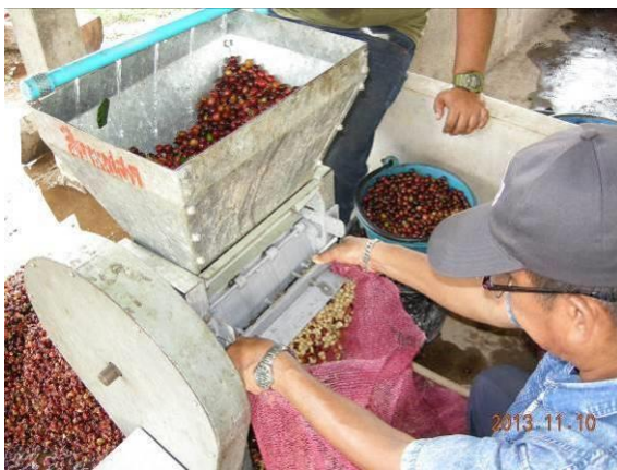
รูปที่ 18 ทดสอบชุดควบคุมการลอกเปลือกแบบแผ่นยางที่กลุ่มแปรรูปกาแฟสวนยาหลวง บ้านสันเจริญ จ.น่าน
