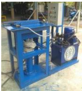
รูปที่ 16 เครื่องมือผลิตวัสดุปลูกกล้วยไม้ควบคุมด้วย PLC : Programmable Logic Controller
