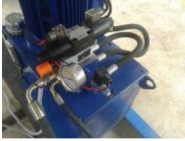
รูปที่ 15 ชุดวาล์วไฟฟ้าและวาล์วระบายแรงดัน : Relief valve
