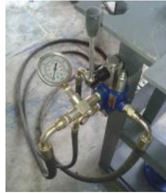
รูปที่ 5 วาล์วคันโยกควบคุมกระบอกไฮดรอลิกขึ้นลง
