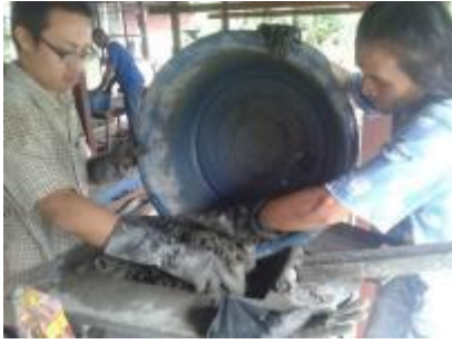
รูปที่ 8 นำส่วนผสมใส่ลงในเครื่องอัด
