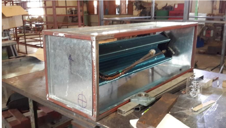
รูปที่ 9 ติดตั้งคอรียเยนกับโครงสร้างกล่อง
