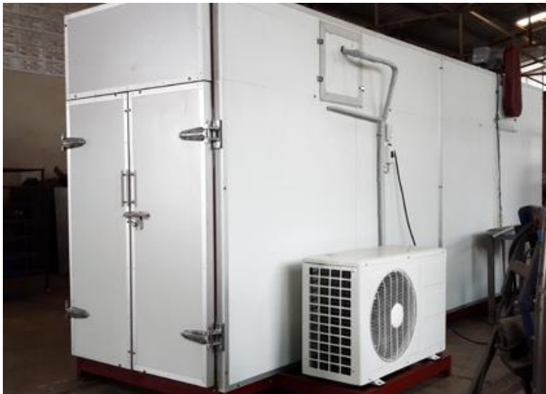
รูปที่ 15 ต้นแบบเครื่องผลิตลมเย็นที่สร้างเสร็จ
