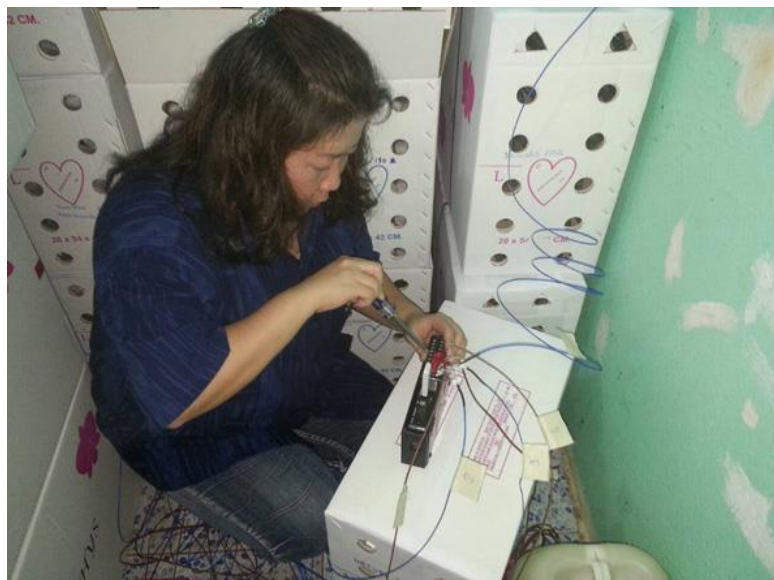
รูปที่ 20 ต่อหัววัดเทอร์โมคัปเปิลเข้ากับดาต้าล็อกเกอร์
