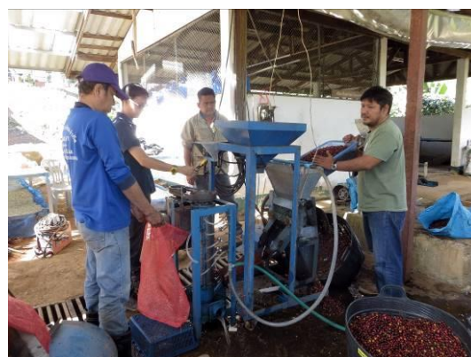
ภาพที่ 3.3 การทดสอบต้นแบบเครื่องขัดล้างเมือกกาแฟเบื้องต้นที่ศูนย์วิจัยเกษตรหลวงเชียงใหม่ (ขุนวาง)
