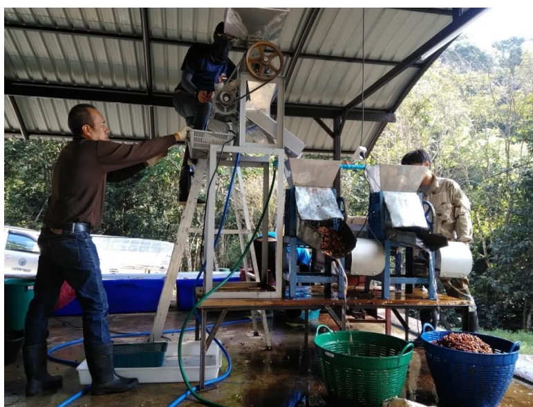
ภาพที่ 2.10 ทดสอบเครื่องคัดแยกผลอ่อนที่ไร่เกษตรกร บ้านป๊อก อ.แม่ฮอน จ.เชียงใหม่
