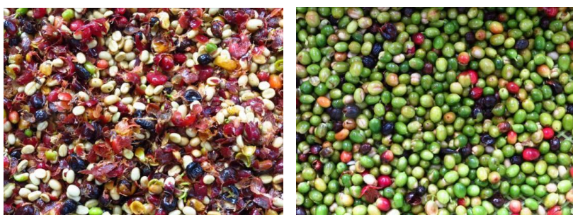
ภาพที่ 2.4 ผลผลิตจากต้นแบบเครื่องตัดแยกผลกาแฟอ่อนแบบปรีดผลกาแฟ
