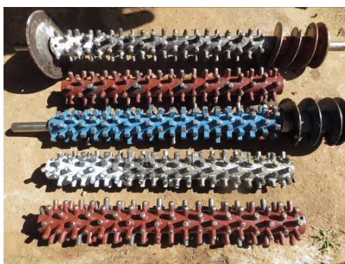
ภาพที่ 3.2 แกนขัดแบบต่างๆ ของต้นแบบเครื่องขจัดล้างเมือกกาแพที่ใช้ทดสอบ
