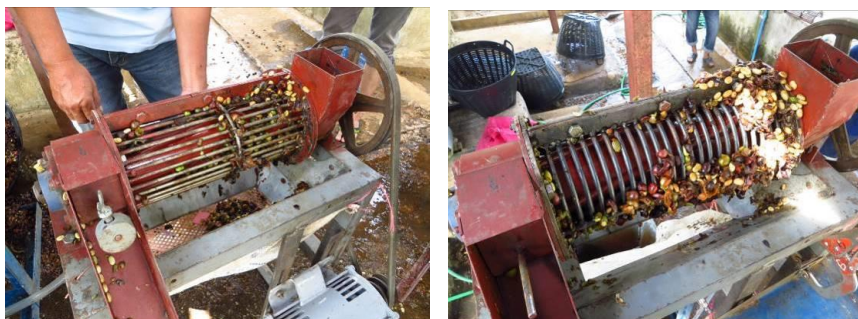
ภาพที่ 2.2 ลักษณะเสื้อตะแกรงแบบแนวนอน (ซ้าย) และแบบแนวตั้ง (ขวา)
