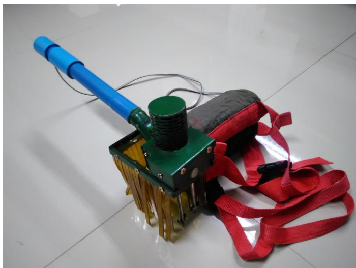
ภาพที่ 1.15 ต้นแบบเครื่องมือเก็บเกี่ยวผลกาแพที่ทำการปรับปรุงแก้ไขแล้ว
