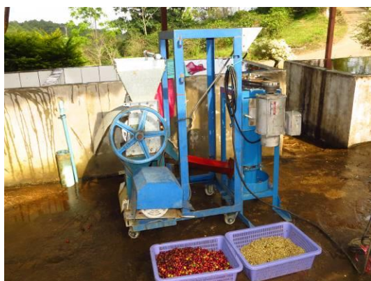
ภาพที่ 3.3 การทดสอบต้นแบบเครื่องขัดล้างเมือกกาแฟเบื้องต้นที่ศูนย์วิจัยเกษตรหลวงเชียงใหม่ (ขุนวาง)
