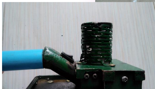
ภาพที่ 1.14 ปรับปรุงก้านรูดแบบสปริงดึงเป็นแบบใช้เส้นลวดสปริง และเปลี่ยนตำแหน่งสวิทช์
