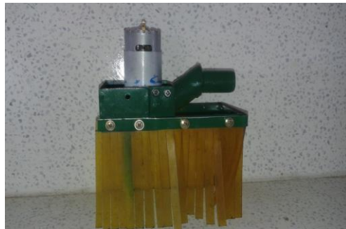
ภาพที่ 1.8 สร้างเครื่องมือเก็บเกี่ยวผลกาแพด้วยวิธีรูต
