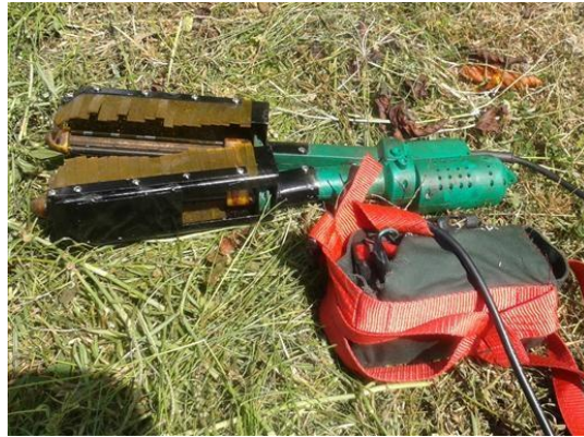
ภาพที่ 1.5 ปรับปรุงเครื่องมือเก็บเกี่ยวผลกาแพชของเวียดนาม
