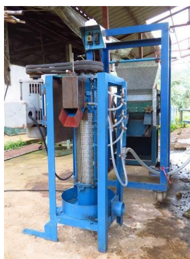
ภาพที่ 3.1 ต้นแบบเครื่องขจัดล้างเมือกกาแพ
