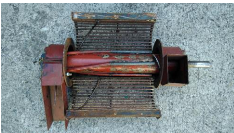
ภาพที่ 2.8 แกนรีดผลกาแฟแบบไม่มีฟันและไม่มีเกลียวกันท้าย
