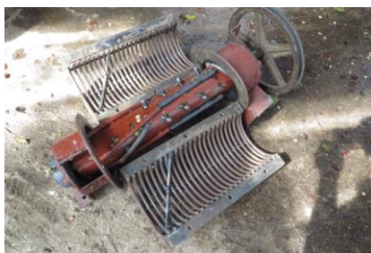
ภาพที่ 2.6 แกนรีดผลกาแฟแบบมีฟันและมีเกลียวกันท้าย
