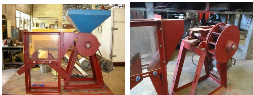
ภาพที่ 2.5 ต้นแบบเครื่องตัดแยกผลกาแฟอ่อนแบบตีผลกาแฟเบื้องต้น
