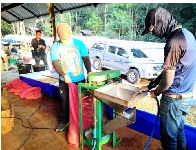
ภาพที่ 3.5 ทดสอบเก็บข้อมูลการใช้งานเครื่องขั้ดล้างเมือกกาแฟอะราบิกา ที่ไร่เกษตรกร บ้านป้อก อ.แม่ออน จ.เชียงใหม่
