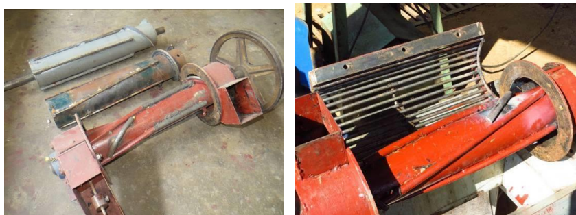
ภาพที่ 2.1 ลักษณะแกนรีดผลกาแฟ
