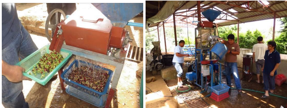
ภาพที่ 2.3 การทดสอบต้นแบบเครื่องตัดแยกผลกาแฟอ่อนแบบปรีดผลกาแฟเบื้องต้น
