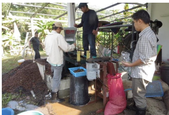
ภาพที่ 3.4 ทดสอบต้นแบบเครื่องขุดล้างเมือกกาแพะราบีก้า ที่กลุ่มวิสาหกิจชุมชนแปรรูปกาแพบ้านแม่แจ่ม อ.เมืองปาน จ.ลำปาง
