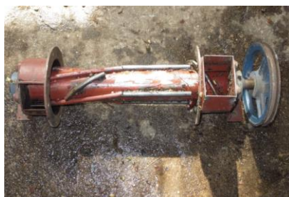
ภาพที่ 2.7 แกนรีดผลกาแฟแบบไม่มีฟันและมีเกลียวกันท้าย
