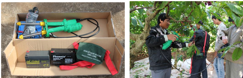
ภาพที่ 1.2 เครื่องมือเก็บเกี่ยวผลกาแพของเวียดนาม
