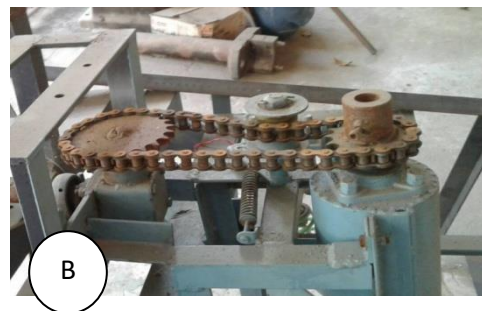
รูปที่ 9 ตำแหน่งการปรับเปลี่ยนระบบส่งกำลัง ทดสอบเปรียบเทียบ
