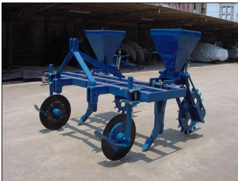
รูปที่ 1 เครื่องหยอดปุ๋ยอ้อยแบบสองแถวที่มีจำหน่ายในท้องตลาด ที่มา: วิชัย และคณะ (2556)
