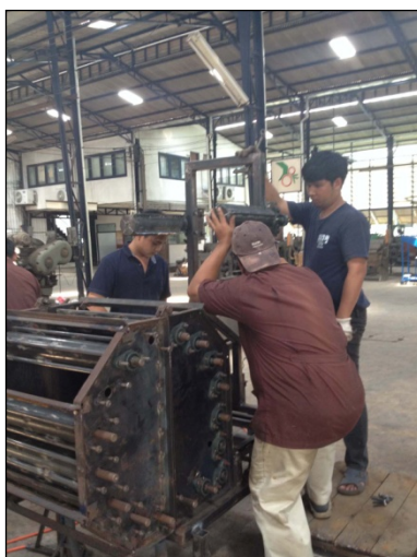
ภาพที่ 8 การติดตั้งลูกกลิ้งสำหรับม้วนใบ เข้ากับโครงสร้างหลัก
