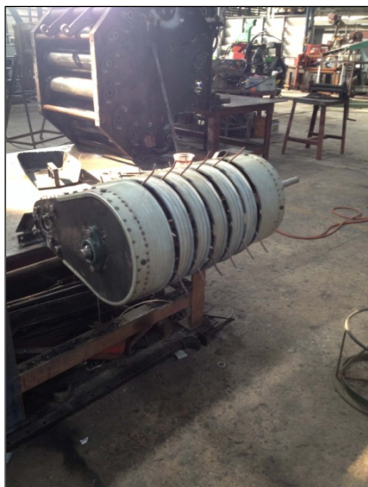
ภาพที่ 9 การประกอบชุดดึงใบอ้อยแห้งจากพื้นดิน เข้ากับห้องม้วนใบ
