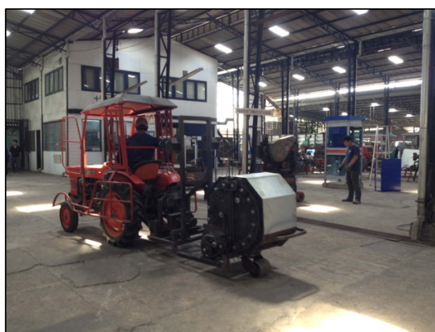
ภาพที่ 12 ต้นแบบ ระบบกลไกรวบรวมใบอ้อย ต่อฟางกับแทรกเตอร์
