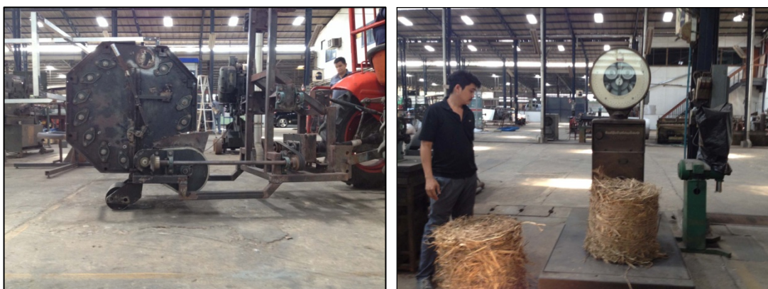
ภาพที่ 11 ด้านซ้าย: ลักษณะการต่อฟาง ด้านขวา: การชั่งน้ำหนักใบอ้อยที่ม้วนได้
