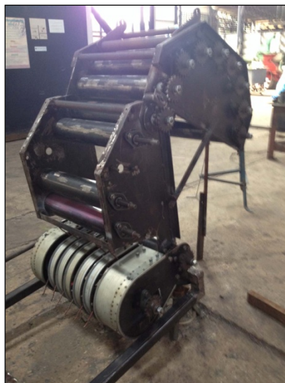
ภาพที่ 9 การประกอบชุดดึงใบอ้อยแห้งจากพื้นดิน เข้ากับห้องม้วนใบ
