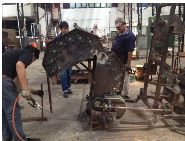
ภาพที่ 10 การประกอบระบบส่งกำลัง
