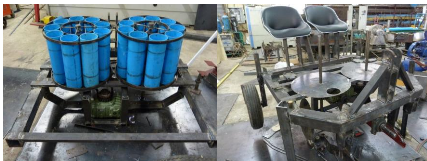
ภาพที่ 6 แบบโครงสร้างและส่วนประกอบบางส่วนของต้นแบบเครื่องปลูกสับประรด
