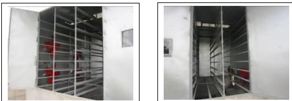
ภาพที่ 1.3-3 แสดงภาพระบบการกระจายลมร้อนด้วยพัดลมและช่องเปิดด้านบนโรงอบแห้งลำไย
