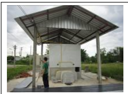
ภาพที่ 1.3-1 แสดงภาพโรงอบแห้งลำไยเนื้อสีทองแบบปรับปรุงใหม่ ณ ศูนย์วิจัยเกษตรวิศวกรรมเชียงใหม่
