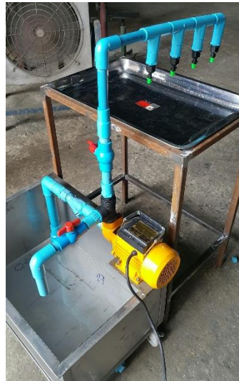
ภาพที่ 2 ระบบควบคุมการพ่นฝอยน้ำเย็น
