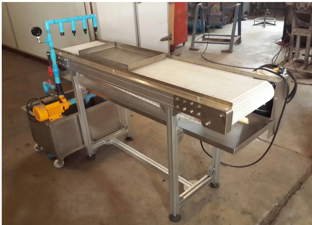
ภาพที่ 7 ต้นแบบระบบลำเลียงในส่วนการพ่นฝอยน้ำเย็นเพื่อให้หอยศัตรูพืชออกจากที่ซ่อนในช่อกล้วยไม้
