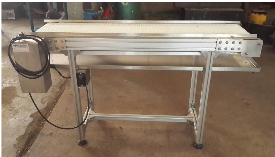
ภาพที่ 5 ต้นแบบสายพานของระบบลำเลียงในส่วนการพ่นฝอยน้ำเย็นเพื่อให้หอยศัตรูพืชออกจากที่ซ่อนในชอกกล้วยไม้
