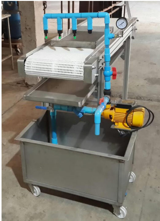
ภาพที่ 6 ต้นแบบระบบลำเลียงในส่วนการพ่นฝอยน้ำเย็นเพื่อให้หอยศัตรูพืชออกจากที่ซ่อนในช่อกล้วยไม้
