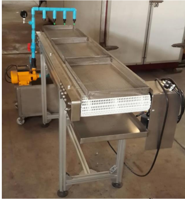
ภาพที่ 8 ถาดบรรจุกล้าไม้ของต้นแบบระบบลำเลียงในส่วนการพ่นฝอยน้ำเย็นเพื่อให้หอยศัตรูพืชออกจากที่ซ่อนในช่อกล้าไม้
