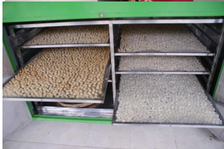
ภาพที่ 4 การทดสอบการอบแห้งลำไยเนื้อสีทองที่กลุ่มวิสาหกิจชุมชนแปรรูป บ้านต้นผึ้ง หมู่ที่ 1 ต.เหมืองง่า อ.เมือง จ.ลำพูน
