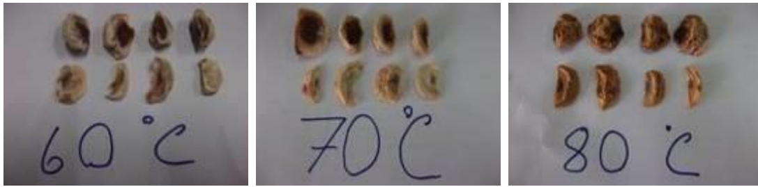
รูปที่ 16. เนื้อมังคุดอบแห้ง 60 c รูปที่ 17. เนื้อมังคุดอบแห้ง 70 c รูปที่ 18. เนื้อมังคุดอบแห้ง 80 c
