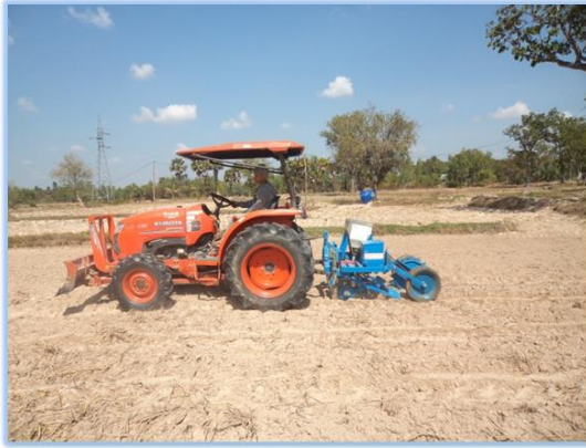
ภาพผนวกที่ 1: เครื่องปลุกงานแบบพ่วงท้ายรถแทรกเตอร์
