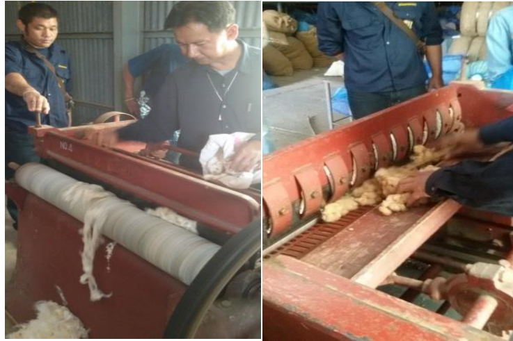
ภาพที่ 9 เครื่องหีบฝ้ายแบบลูกกลิ้งเดี่ยว ณ ศูนย์วิจัยพืชไร่นครสวรรค์
