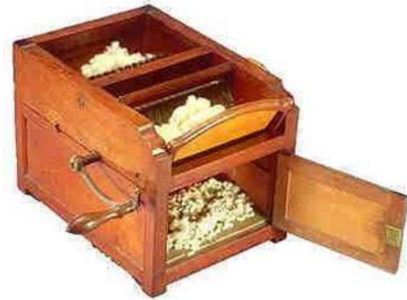
ภาพที่ 2 เครื่องหีบฝ้ายแบบฟันเลื่อย (saw gin)
