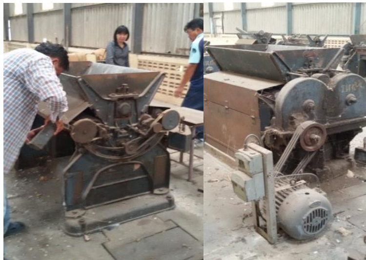
ภาพที่ 10 เครื่องหีบฝ้ายแบบลูกกลิ้งคู่ ณ ศูนย์วิจัยพืชไร่นครสวรรค์
