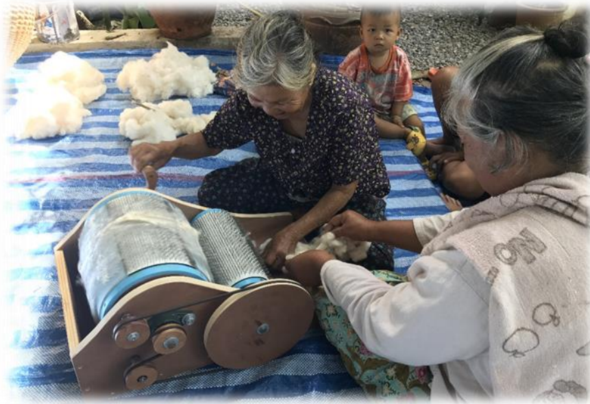
ภาพที่ 15 เครื่องสานฝ้ายต้นแบบตีฟูกเส้นฝ้ายต่อครั้ง 25 กรัม
