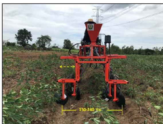
ภาพที่ 10 แปลงมันพันธุ์ระยะของ 72 อายุ 2 เดือน และปรับความกว้างของล้อ
