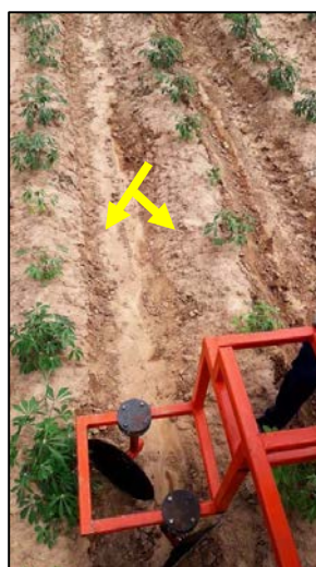
ภาพที่ 16 วิธีปรับความกว้างของพาด ให้เหมาะสมกับร่องปลูก
