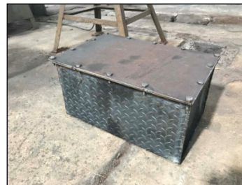
ถังเก็บน้ำมันไฮดรอลิก
