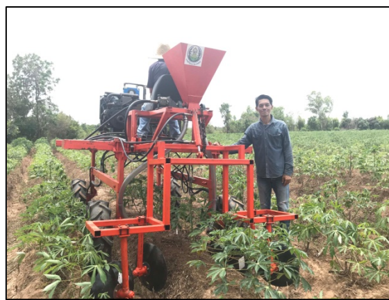
ภาพที่ 13 ผ่านกำจัดวัชพืช รังคล่อมร่องปลูก
