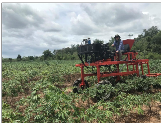
ภาพที่ 13 ผ่านกำจัดวัชพืช รังคล่อมร่องปลูก
