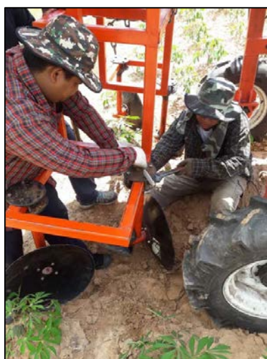
ภาพที่ 16 วิธีปรับความกว้างของพาด ให้เหมาะสมกับร่องปลูก
