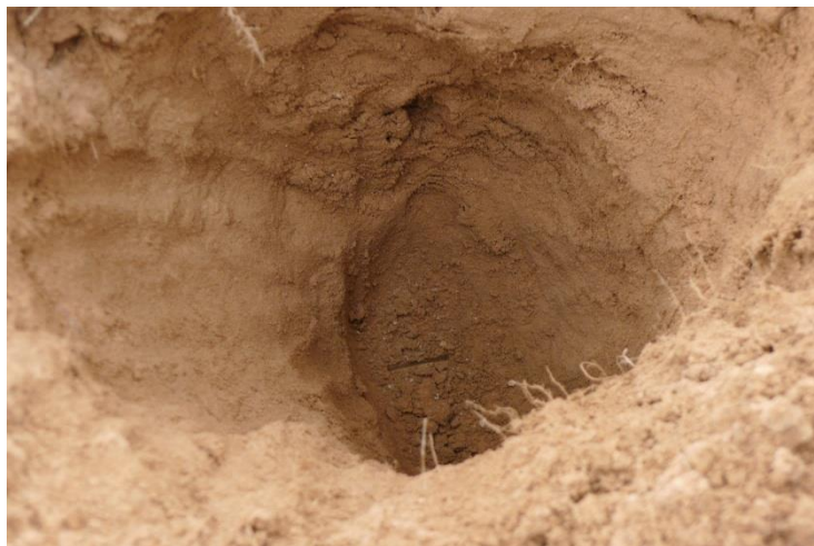
รูปที่ 15 ดินภายหลังระเบิดดินดาน ที่ความลึก 40-45 เซนติเมตร แต่เมื่อนำต้นแบบที่ 2 มาทดสอบในแปลงปลูกมันสำปะหลัง ที่ จ.นครราชสีมา ซึ่งเป็นดิน ร่วนเหนียว ที่มีความชื้นดิน 13.5% พบว่า น้ำสำหรับรับแรงไถ ไม่สามารถทนแรงได้ เกิดการฉีกขาด และชาไถเกิดการบิดตัว
