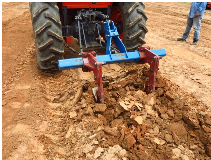
รูปที่ 17 ไถระเบิดดินดานต้นแบบที่ 3
