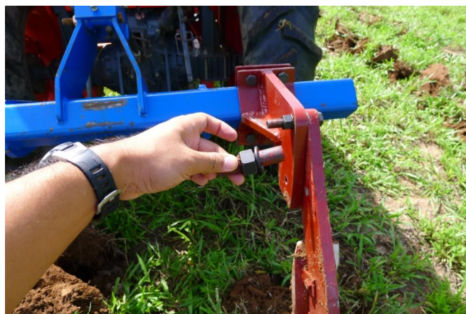
รูปที่ 13 น็อตไม่สามารถรับแรงได้ เกิดความเสียหายขึ้น
