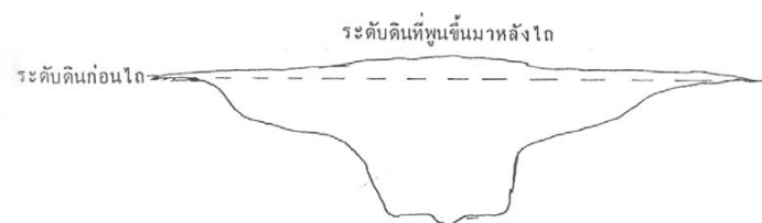
รูปที่ 9 พื้นที่หน้าตัดของดินที่แตกร่วนเมื่อใช้ไถดินดานชนิดติดปีก ที่มา มงคล (2530)
