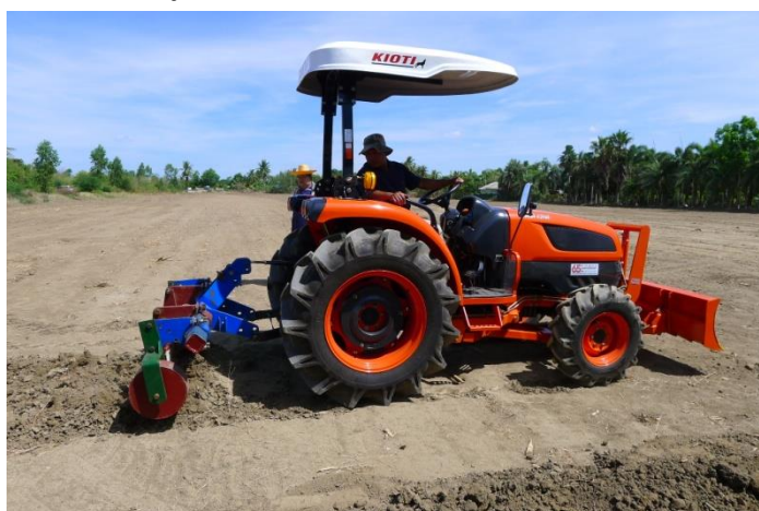
รูปที่ 19 ล้อควบคุมความลึกในการไถขณะใช้งานไถระเบิดดินดาน
