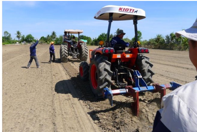
รูปที่ 25 ทดสอบแรงฉุดลากในขณะที่ไถระเบิดดินดานทำงาน
