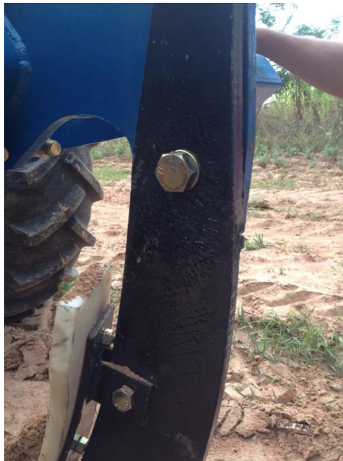
รูปที่ 12 ทดสอบในแปลงปลูกอ้อย พบว่า โครงสร้างไถรับแรงไม่ได้ เกิดการเสียรูป
