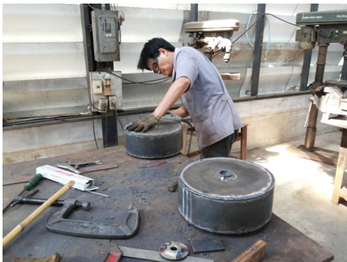
รูปที่ 18 ล้อควบคุมความลึกในการไถ
