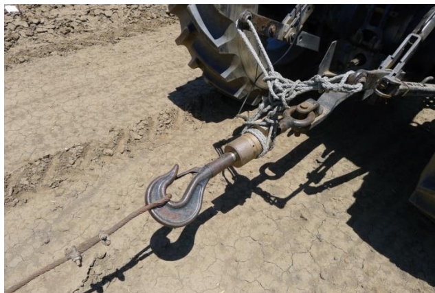
รูปที่ 21 Load Cell ขนาด 5 ตัน ติดตั้งระหว่างรถ 2 คัน
