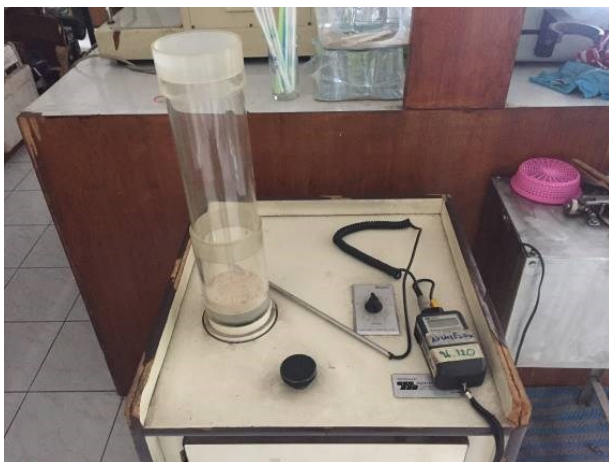
รูปที่ 3 ประยุกต์ใช้เครื่องคัดขนาดเมล็ดพืชขนาดเล็กในการวัดแรงลอยตัวของชิ้นมันเส้น และวัสดุเจือปน
