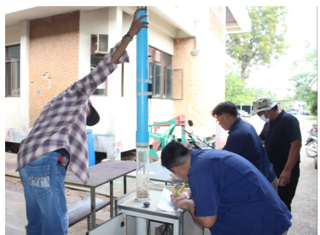
รูปที่ 3 ประยุกต์ใช้เครื่องคัดขนาดเมล็ดพืชขนาดเล็กในการวัดแรงลอยตัวของชิ้นมันเส้น และวัสดุเจือปน
