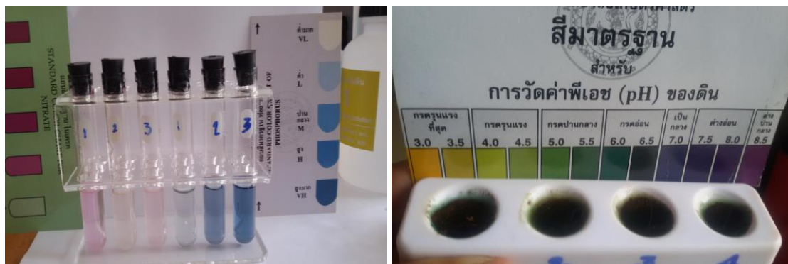
รูปที่ 4 การวิเคราะห์ดิน โดยใช้ชุด Test Kit
