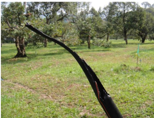
ภาพที่ 6 ท่อ PE ในศูนย์วิจัยพืชสวนจันทบุรีที่ถูกเครื่องตัดหญ้าซ้ออ่อนตัดเสียหาย
