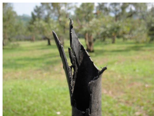
ภาพที่ 6 ท่อ PE ในศูนย์วิจัยพืชสวนจันทบุรีที่ถูกเครื่องตัดหญ้าซ้ออ่อนตัดเสียหาย
