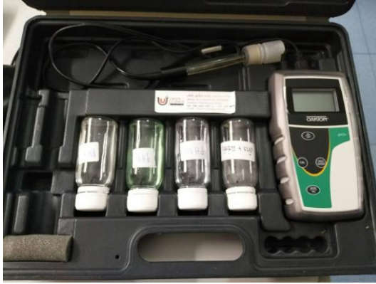
รูปที่4 pHmeter ยี่ห้อ OAKTON รุ่น pH5+
