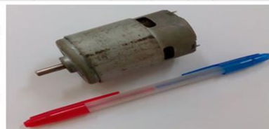
ภาพที่ 7 ลักษณะของมอเตอร์ที่ใช้กับเครื่องตัดแต่งแบบมอเตอร์เกียร์ทดกำลัง
