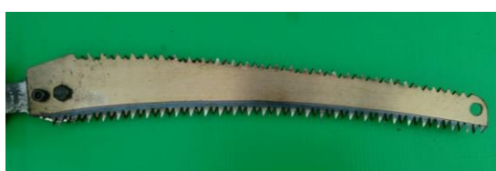
ภาพที่ 23 ลักษณะเลื่อยชักที่ทำการดัดแปลงให้มีฟันเลื่อยด้านบน
