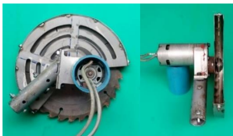
ภาพที่ 27 ตำแหน่งมอเตอร์แบบเดิมอยู่ที่หัวห้องเกียร์
