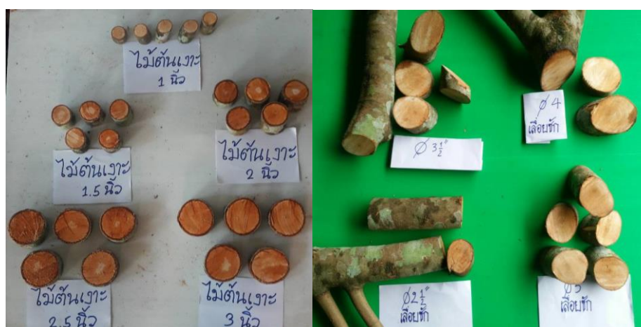
ภาพที่ 24 การทดสอบเครื่องตัดแต่งกิ่งแบบเกียร์ทดกำลังแบบเลื่อยวงเดือน (ซ้าย) และแบบเลื่อยชัก (ขวา)
