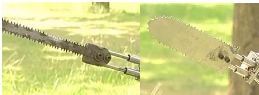
ภาพที่ 19 ตัวอย่างเลื่อยซีกที่ปรับปรุงให้มีฟันทั้งด้านบนและด้านล่าง (วิชา หมั่นทำการ)
