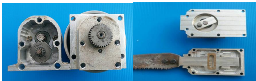
ภาพที่ 15 ห้องเกียร์ (ซ้าย) และห้องลูกเบี้ยว (ขวา) ของเครื่องตัดแต่งกิ่งแบบมอเตอร์เกียร์ทดกำลังแบบเลื่อยชัก
