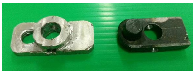
ภาพที่ 17 ลักษณะลูกเบี้ยวอลูมิเนียม (ซ้าย) และลูกเบี้ยวเหล็ก (ขวา) ของเครื่องตัดแต่งกิ่งแบบมอเตอร์เกียร์ทดกำลังและเลื่อยชัก
