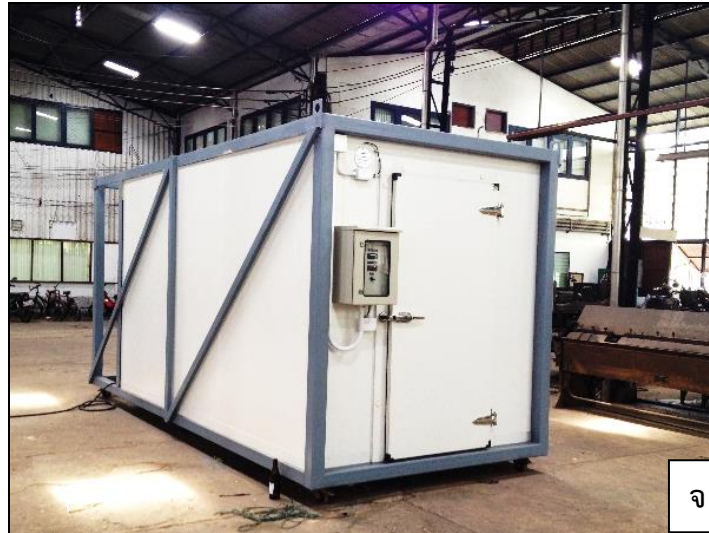
ภาพที่ 13 (ก) การประกอบโครงสร้าง (ข) การประกอบผนังห้องเย็น (ค) การติดตั้งคอยล์เย็น (ง) การติดตั้งระบบทำความเย็น (จ) ต้นแบบห้องเย็น
