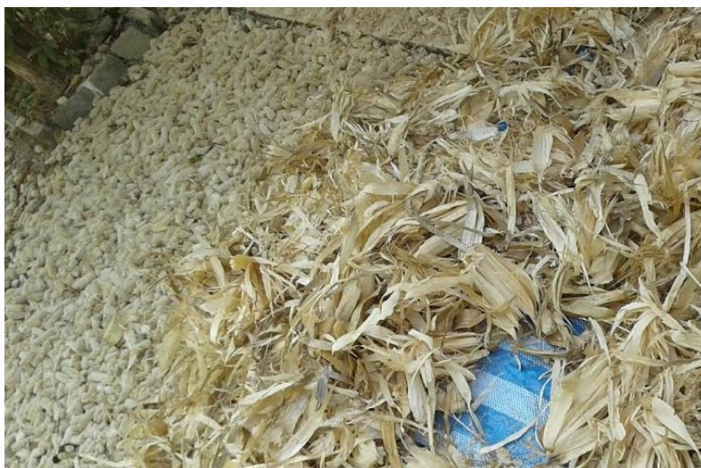
รูปที่ 7 ชังและเปลือกที่แยกตัวออกจากกันหลังการทดสอบ
