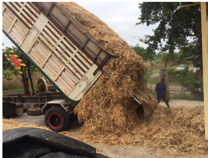
ภาพที่ 22 การตัมพ์แล้วเกิดปัญหาเปลือกและอัดตัวแน่น
