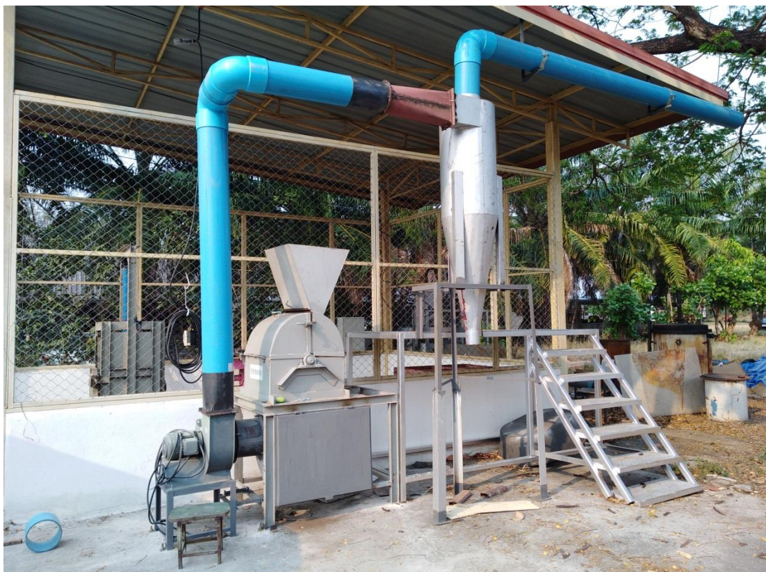
ภาพที่ 30 โรงงานต้นแบบกระบวนการแปรรูปเปลือกและซังสำหรับการเป็นเชื้อเพลิง
