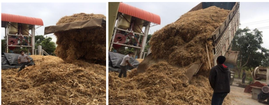
ภาพที่ 23 ใช้แรงงานคนในการแก้ไขเปลือกและซังข้าวโพดที่อัดตัว
