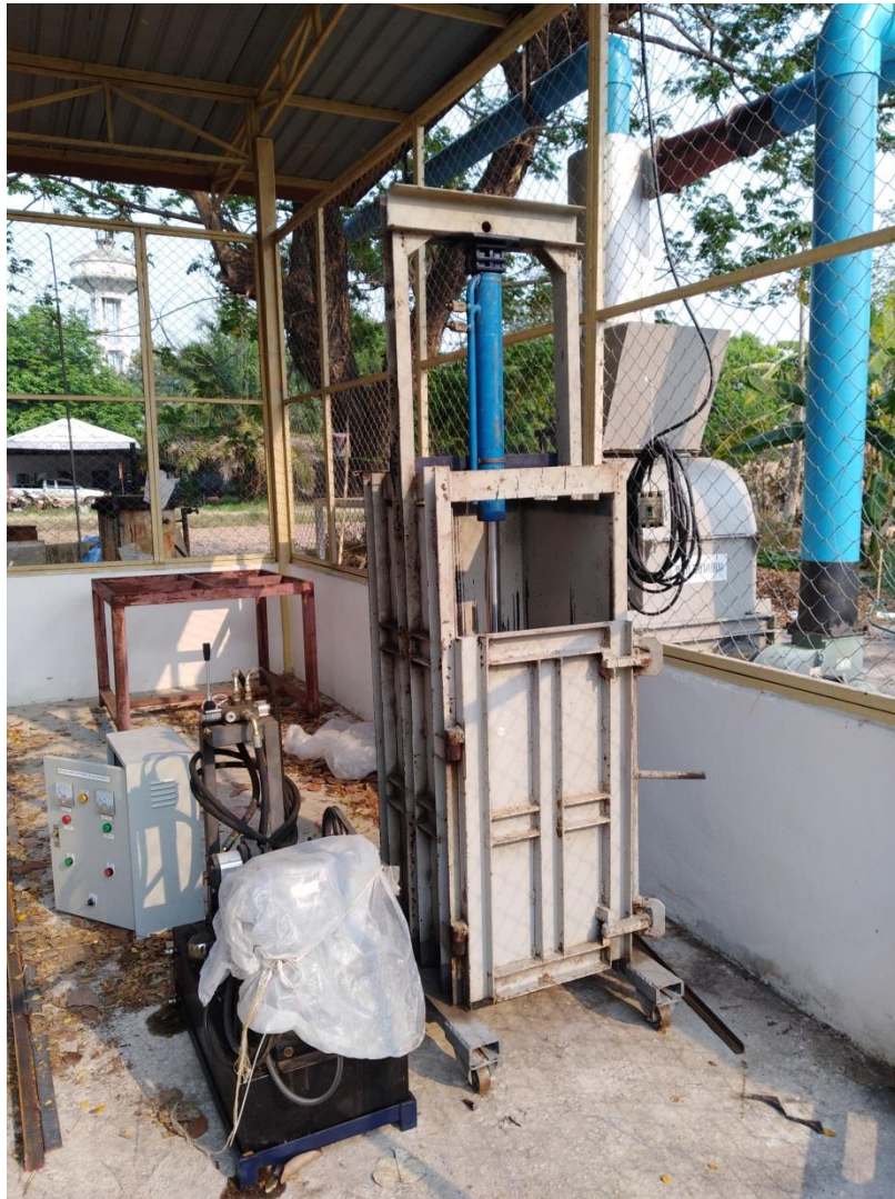
ภาพที่ 31 โรงงานต้นแบบกระบวนการอัดเปลือกเป็นเชื้อเพลิง
