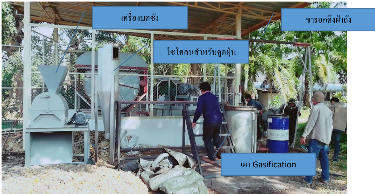
ภาพที่ 29 การสร้างโรงงานต้นแบบเพื่อแปรรูปเปลือกและซังสำหรับการเป็นเชื้อเพลิง
