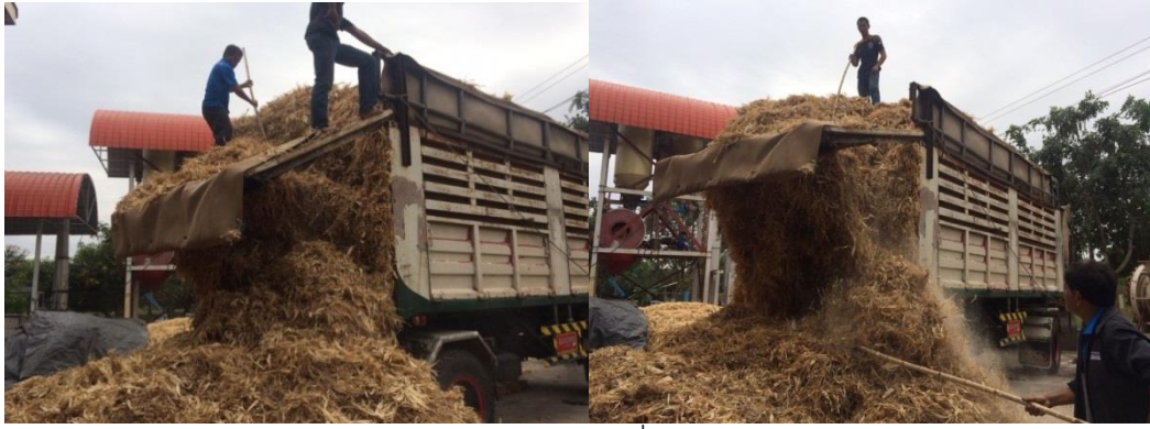
ภาพที่ 24 ใช้แรงงานคนในการแก้ไขเปลือกและซังข้าวโพดที่อัดตัวและใช้แรงงานคนในการแก้ไขเปลือกและซังข้าวโพดที่อัดตัว
