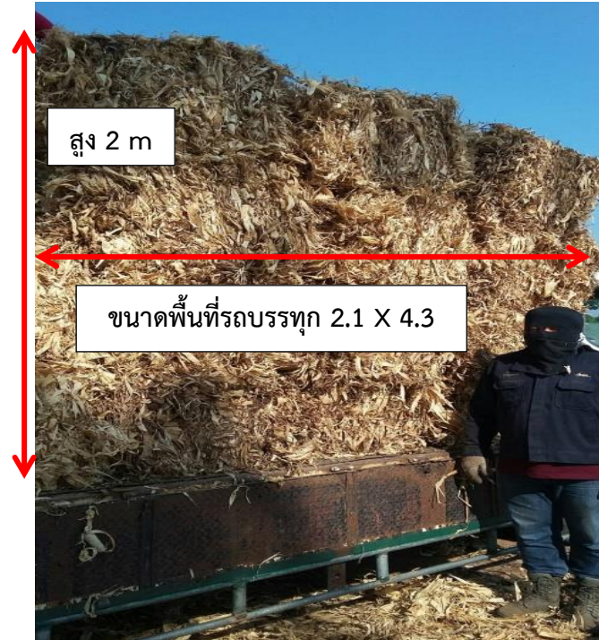
ภาพที่ 27 การจัดเรียงก้อนชีวมวลสำหรับขนส่ง 1 ครั้ง สำหรับรถบรรทุกที่มี (รถบรรทุก 6 ล้อขนาดกลาง) สามารถบรรทุกชีวมวลได้เต็มอัตราจำนวน 68 ก้อน
