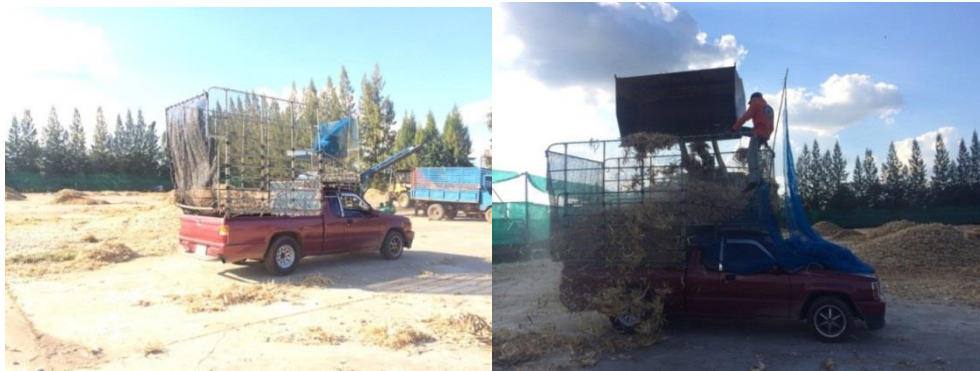
ภาพที่ 14 รถกะบะ และการขนย้ายซังและเปลือกข้าวโพดจากลานขึ้นบรรทุกบนรถกะบะด้วยรถตัด (CAT รุ่น 910F)
