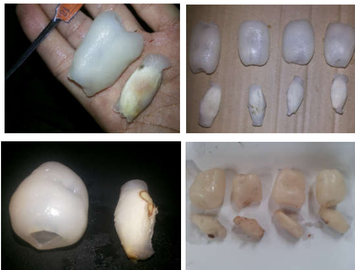
รูปที่ 9 ผลเงาะจากการคว้านด้วยแรงงานคน(แถวบน)และ ผลเงาะจากการคว้านด้วยเครื่องคว้านเมล็ดออกจากเนื้อเงาะแบบกึ่งอัตโนมัติ(แถวล่าง)
