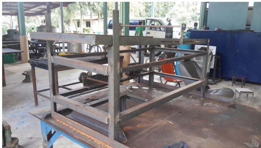
ภาพที่ 8 ติดตั้งแกนเพลาชับชุดแปรงตัดหนามผลสละ
