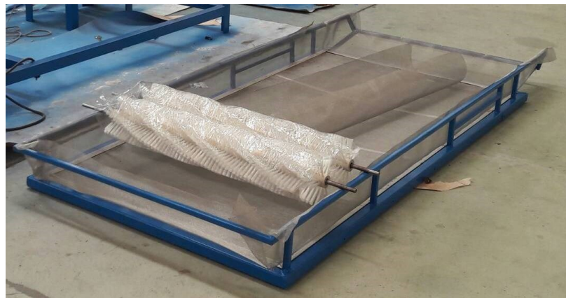
ภาพที่ 23 ชุดตะแกรงโยกและแปรงตัดหนาม
