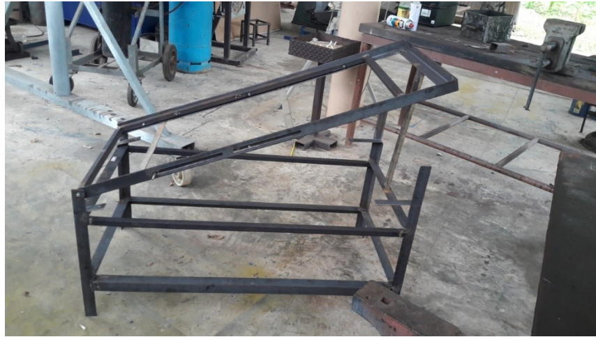
ภาพที่ 7 โครงสร้างของเครื่องตัดหนามผลสละที่สามารถยกมุมเอียงตะแกรงโยกได้
