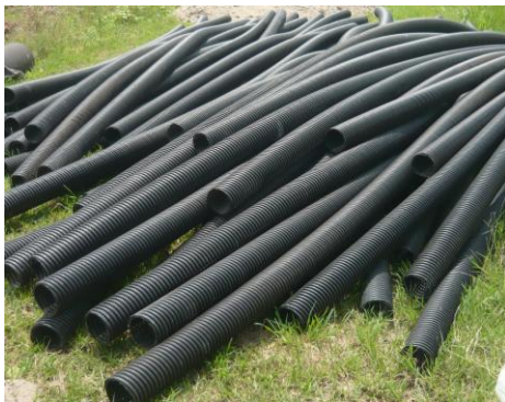
(ก) ท่อระบายน้ำใต้ดิน
