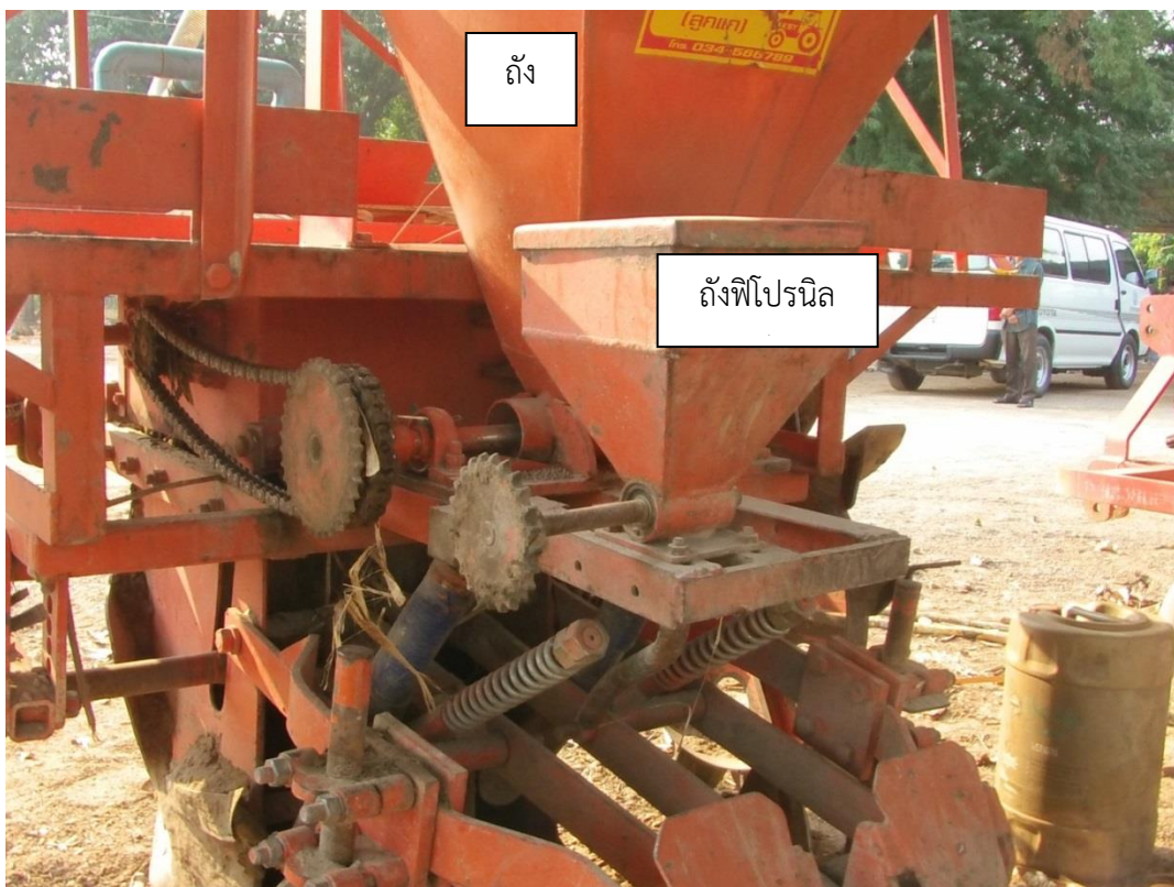
ภาพที่ 8 เครื่องปลูกอ้อยติดทำयरรถแทรกเตอร์พร้อมหยอดปุ๋ยและสารป้องกันกำจัดแมลงชนิดเม็ด
