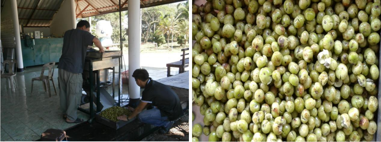
ภาพที่ 8 ทดสอบต้นแบบเครื่องบีบผลมะขามป้อมหลังปรับปรุง
