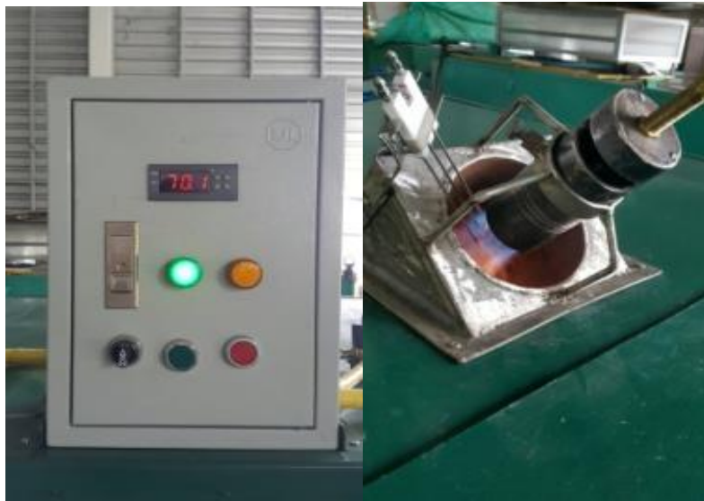
ภาพที่ 6 ส่วนประกอบต่างๆของเครื่องต้นแบบเครื่องอบแห้งมะขามป้อม
