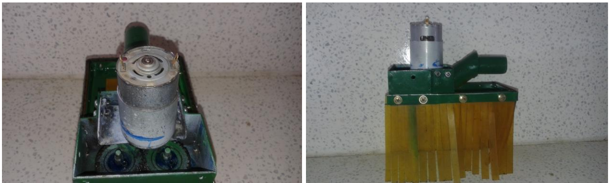
รูปที่ 8 สร้างเครื่องมือเก็บเกี่ยวผลกาแพด้วยวิธีรูต
