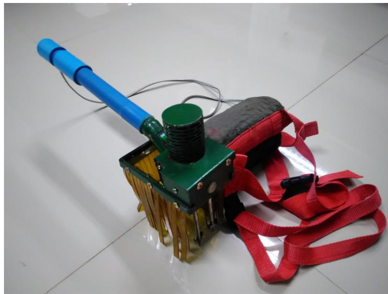
รูปที่ 15 ต้นแบบเครื่องมือเก็บเกี่ยวผลกาแพที่ทำการปรับปรุงแก้ไขแล้ว
