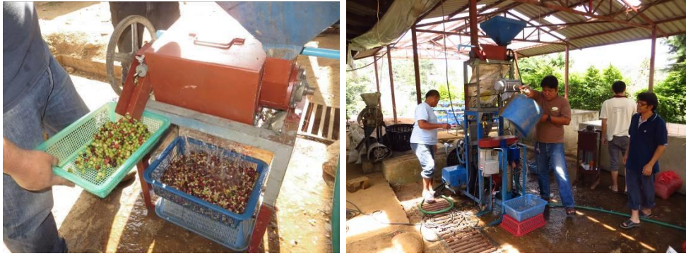
ภาพที่ 3 การทดสอบต้นแบบเครื่องคัดแยกผลกาแพอ่อนแบบบริดผลกาแพเบื้องต้น
