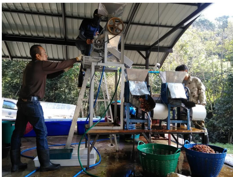
ภาพที่ 10 ทดสอบเครื่องคัดแยกผลอ่อนที่ไร่เกษตรกร บ้านปोक อ.แม่อน จ.เชียงใหม่
