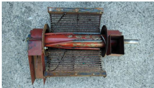
ภาพที่ 8 แกนรีดผลกาแฟแบบไม่มีฟันและไม่มีเกลียวก้นท้าย
