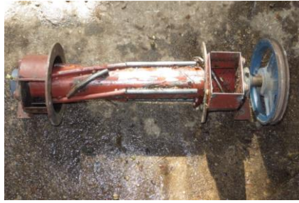
ภาพที่ 7 แกนรีดผลกาแฟแบบไม่มีฟันและมีเกลียวก้นท้าย
