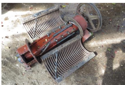
ภาพที่ 6 แกนรีดผลกาแฟแบบมีฟันและมีเกลียวกันท้าย
