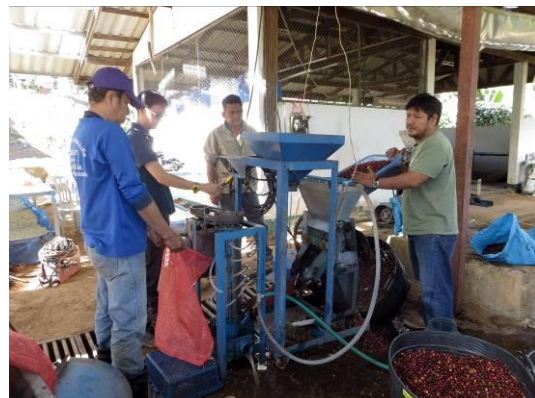
รูปที่ 3 การทดสอบต้นแบบเครื่องขัดล้างเมือกกาแฟเบื้องต้นที่ศูนย์วิจัยเกษตรหลวงเชียงใหม่ (ขุนวาง)
