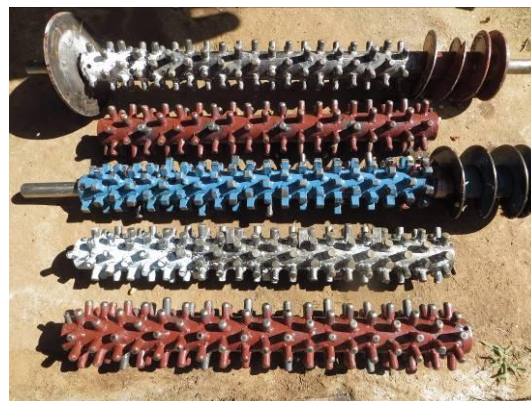
รูปที่ 2 แกนขัดแบบต่างๆ ของต้นแบบเครื่องขัดล้างเมื่อกกาแฟที่ใช้ทดสอบ
