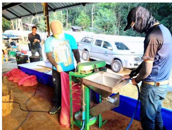
ภาพที่ 5 ทดสอบเก็บข้อมูลการใช้งานเครื่องขัดล้างเมล็ดกาแฟอะราบิกา ที่ไร่เกษตรกร บ้านป้อก อ.แม่ฮอน จ.เชียงใหม่
