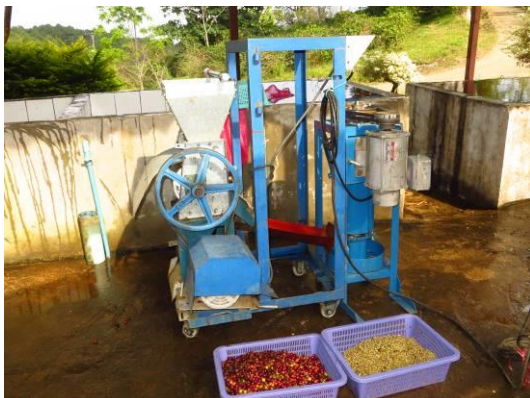
รูปที่ 3 การทดสอบต้นแบบเครื่องขัดล้างเมือกกาแฟเบื้องต้นที่ศูนย์วิจัยเกษตรหลวงเชียงใหม่ (ขุนวาง)
