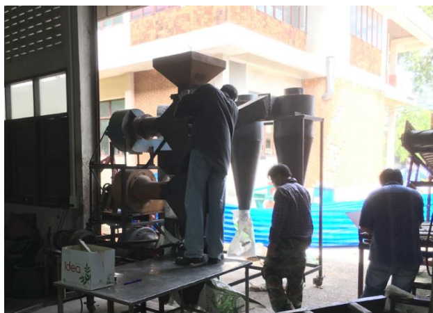
รูปที่ 9 ขณะทดสอบระบบการทำความสะอาดมันเส้นที่มีการติดตั้งไซโคลนแล้ว
