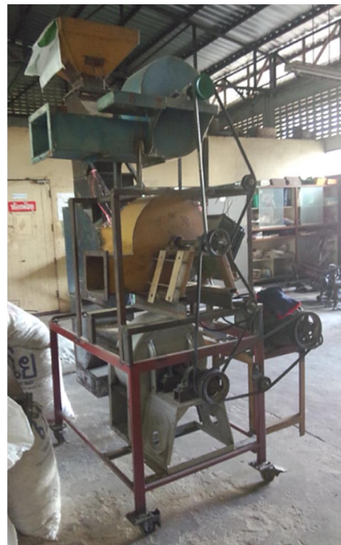
รูปที่ 7 ต้นแบบเครื่องทำความสะอาดมันเส้น ที่สามารถคัดแยกเศษสิ่งเจือปนขนาดใหญ่ได้
