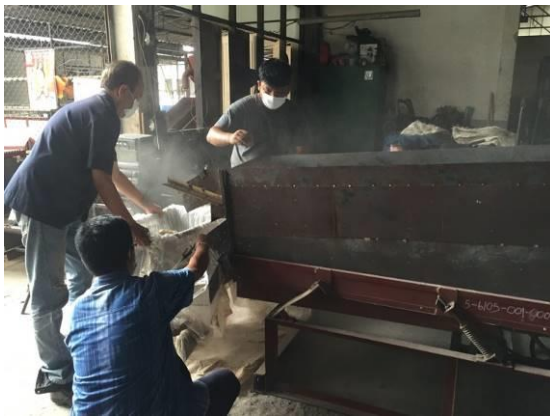
รูปที่ 1 ตะแกรงโยก 3 ชั้น ที่สามารถตัดแยกขนาดได้เป็น 4 ขนาด
