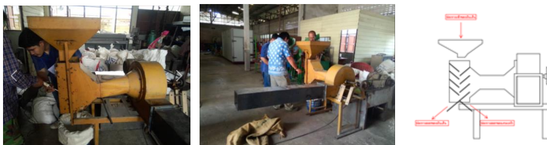
รูปที่ 5 ชุดทดสอบเพื่อศึกษาความเป็นไปได้ในการตัดแยกเศษวัสดุเจือปนออกจากมันเส้น
