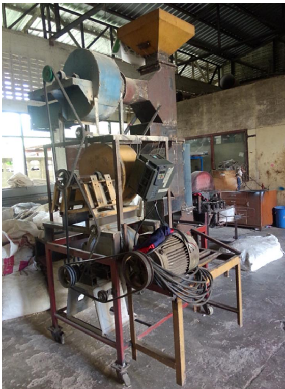
รูปที่ 7 ต้นแบบเครื่องทำความสะอาดมันเส้น ที่สามารถคัดแยกเศษสิ่งเจือปนขนาดใหญ่ได้
