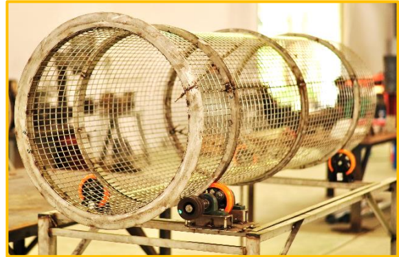
รูปที่ 13 ตะแกรงสแตนเลสหมุนกลมแยกเมล็ดโกโก้
