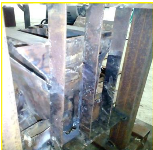
รูปที่ 11 ชุดผ่าผลโกโก้แบบผ่านใบมีดที่พัฒนาและปรับปรุงขึ้นใหม่จากเหล็กเป็นสแตนเลส
