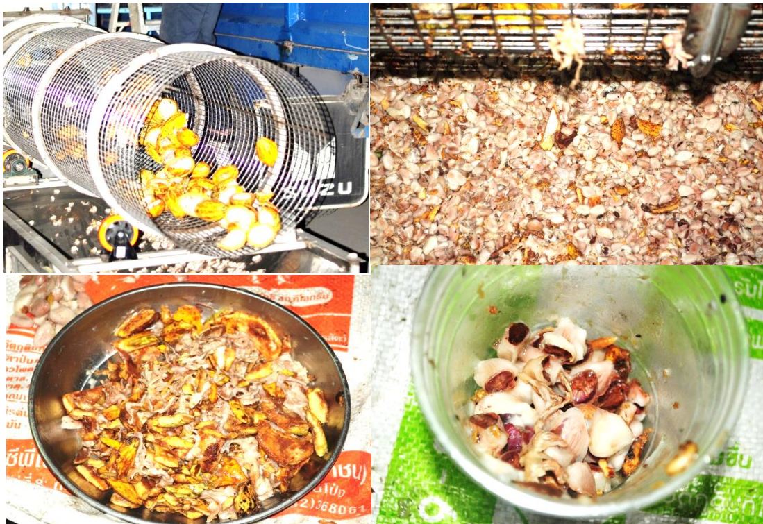
รูปที่ 16 ทดสอบเครื่องต้นแบบครั้งที่ 1 เพื่อหาความเร็วรอบที่เหมาะสมในของชุดตะแกรงแยกเมล็ดโกโก้
