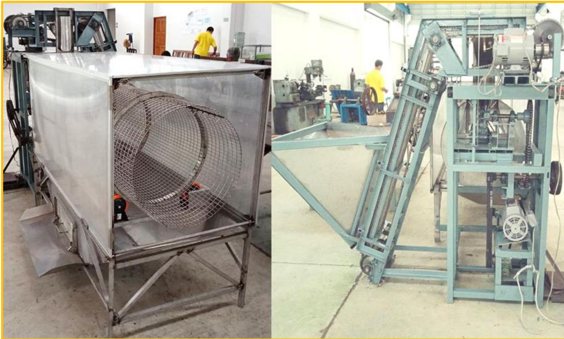
รูปที่ 23 เครื่องต้นแบบแยกเมล็ดโกโก้จากผลพร้อมทดสอบครั้งที่ 2
