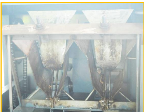
รูปที่ 19 ชุดผ่าผล 2 ช่องและช่องตัววีรับผลกว้าง
