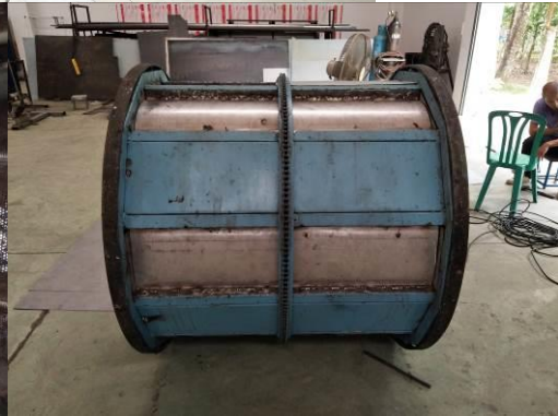
รูปที่ 14 การสร้างเครื่องอบแห้งแบบโรตารี
