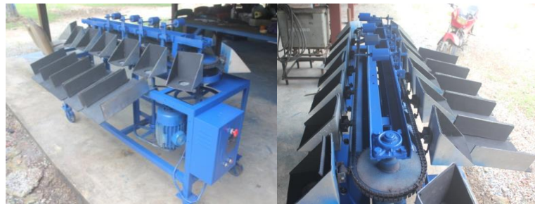
เครื่องต้นแบบเครื่องคัดแยกขนาดผลผลิตน้อยหน้าโดยใช้น้ำหนัก ที่นำมาปรับปรุงแก้ไข
