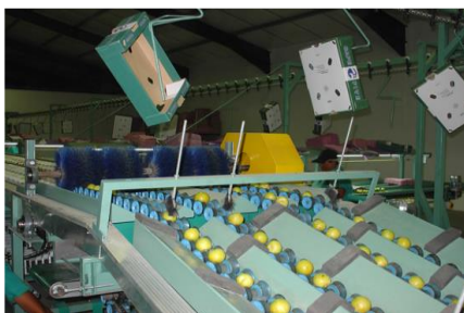
เครื่องคัดขนาดผลส้มแบบสายพานทึบ (belt sizer)
