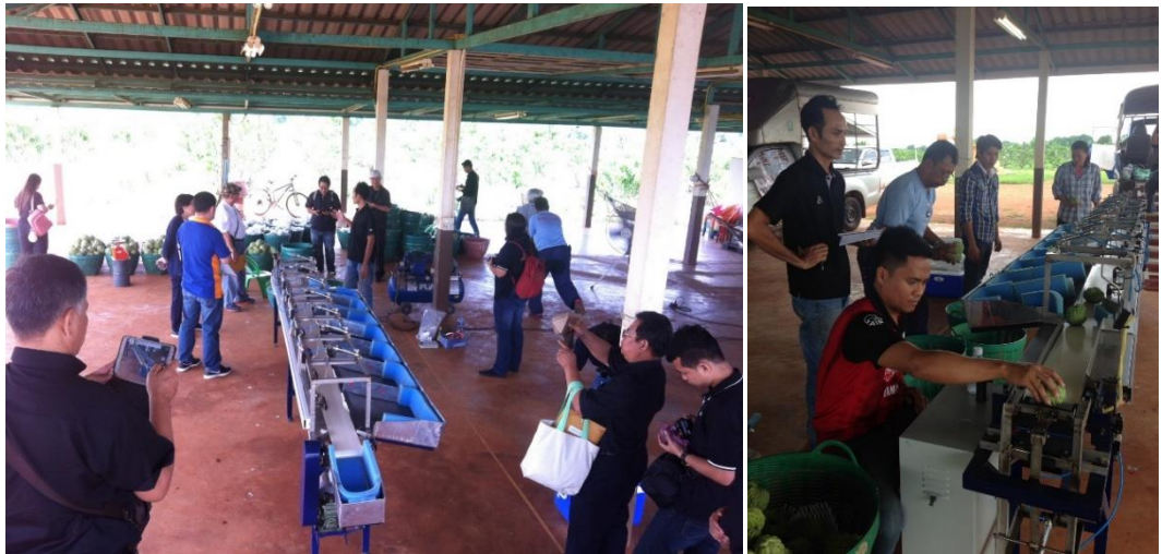
ภาพที่ 10 การทดสอบเครื่องคัดขนาดผลน้อยหน้าต้นแบบที่ ในจุดรวบรวมผลผลิตเพื่อคัดบรรจุ ของเกษตรกร
