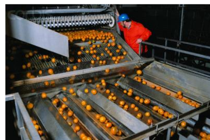
เครื่องคัดขนาดผลส้มแบบสายพานเจาะรู (Perforated conveyor sizer)
