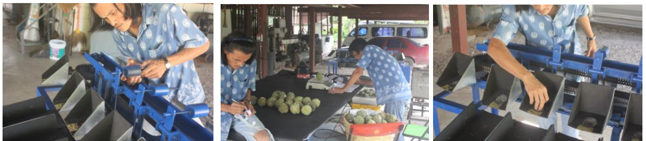
ภาพที่ 6 การปรับตั้งสถานีซึ่งน้ำหนักรีดเครื่องตัดแยกขนาดผลผลิตน้อยหน้าตามน้ำหนักมาตรฐาน
