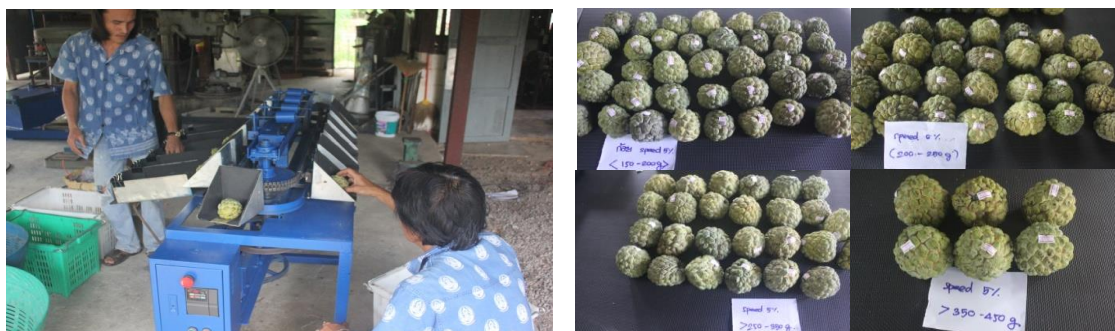
ภาพที่ 8 การทดสอบเครื่องตัดแยกขนาดผลผลิตน้อยหน้าโดยน้ำหนัก(ซ้าย)และผลน้อยหน้าจากการตัดแยกโดยเครื่องตัดแยกขนาดผลผลิตน้อยหน้าโดยน้ำหนัก(ขวา)
