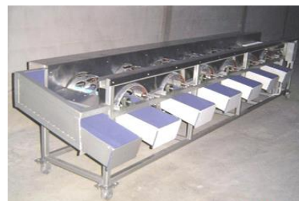
เครื่องคัดขนาดผลส้มแบบสายพานเจาะรู (Perforated conveyor sizer)
