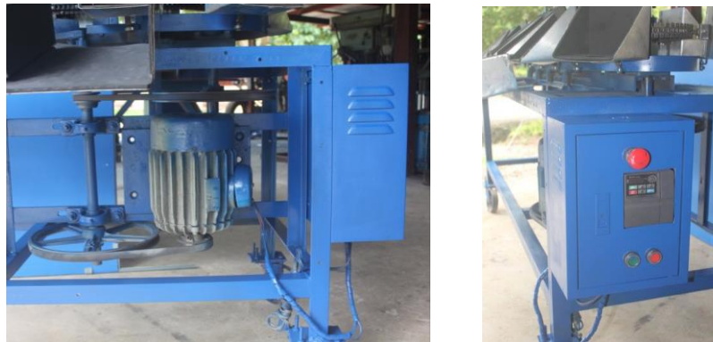
ภาพที่ 5 แสดงชุดควบคุมความเร็วในการตัดแยก และมอเตอร์ต้นกำลัง
