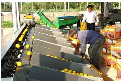
เครื่องคัดขนาดผลส้มแบบสายพานทึบ (belt sizer)
