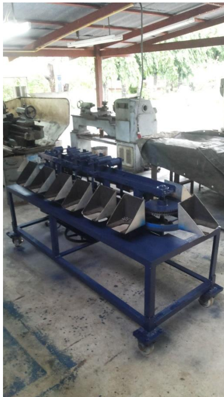
ภาพที่ 3 เครื่องต้นแบบที่1 เครื่องคัดแยกขนาดผลผลิตน้อยหน่าโดยใช้น้ำหนัก
