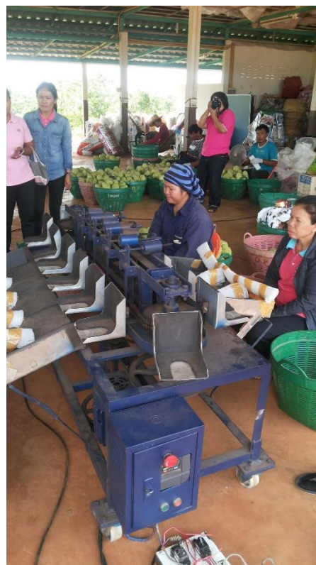
ภาพที่ 3 เครื่องต้นแบบที่1 เครื่องคัดแยกขนาดผลผลิตน้อยหน่าโดยใช้น้ำหนัก
