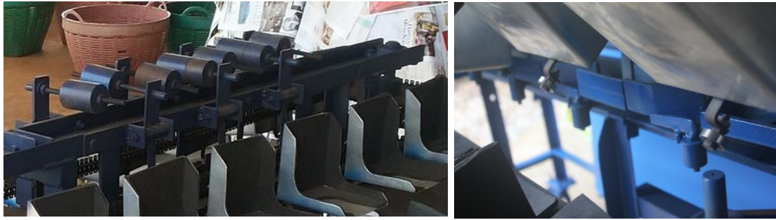
ภาพที่ 4 แสดงตลับน้ำหนักระงับน้ำหนักรีดเครื่องตัดแยกขนาดผลผลิตน้อยหน้า และแสดงสถานีซึ่งน้ำหนักรีด
