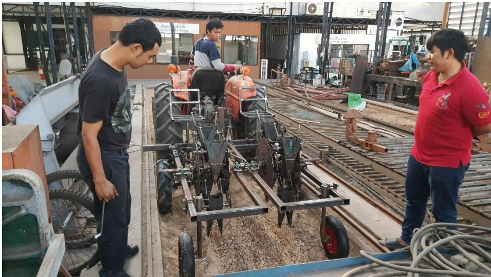
ภาพที่ 13 การทดสอบการทำงานของเครื่องปลุก
