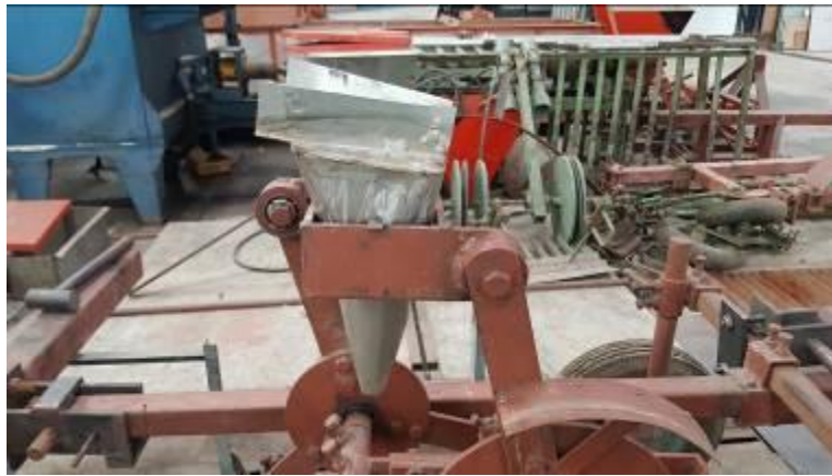
ภาพที่ 8 การประกอบถ้วยปลุกกับเครื่องปลุก
