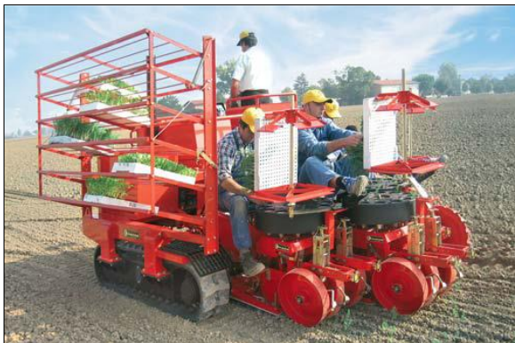
ภาพที่ 3 เครื่องปลูกพืชแบบขับเคลื่อนด้วยตัวเอง (Self propelled utility transplanter)
