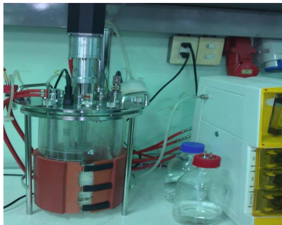
รูปที่ 14 การเลี้ยงเชื้อ Lactococcus 1520 ในถังหมักด้วยอาหารนมถั่วเหลืองภายใต้ ไนโตรเจน อุณหภูมิ 30°C อัตราการคน 80 รอบต่อนาที
