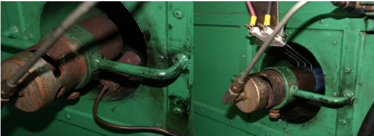
ภาพที่ 32 เขม่าที่เกิดจากการใช้หัวล่อแก๊สมานาน
