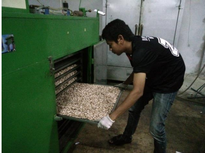
ภาพที่ 13 ทำการทดสอบในห้องทดลองด้วยเครื่องอบแห้งลมร้อนของสถาบันวิจัยเกษตรวิศวกรรม
