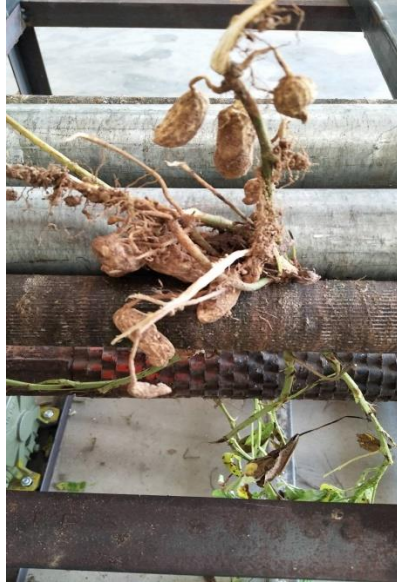
รูปที่14การปลิดฝักถั่วลิสงด้วยลูกกลิ้ง
