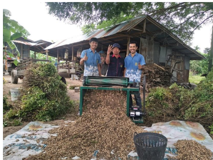
รูปที่21 การทดสอบการปลิดฝักเครื่องต้นแบบ
