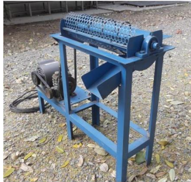
ฉ.เครื่องผลิตฝักถั่วลิสงแบบเกษตรกรแบบใช้คนป้อน
