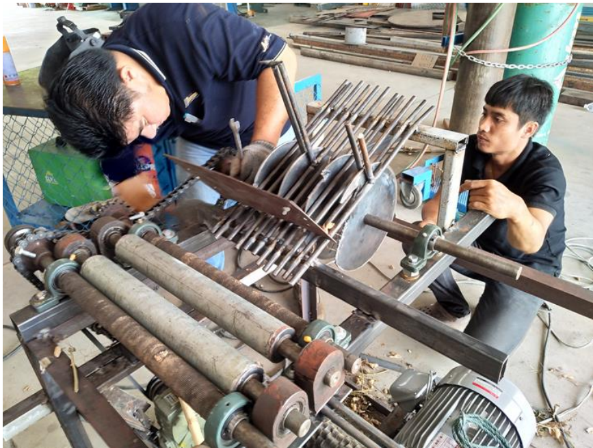
รูปที่17การทดสอบการปลิดแบบใช้งานปลิดแบบเขี้ยวร่องต้นแบบร่องเดียว
