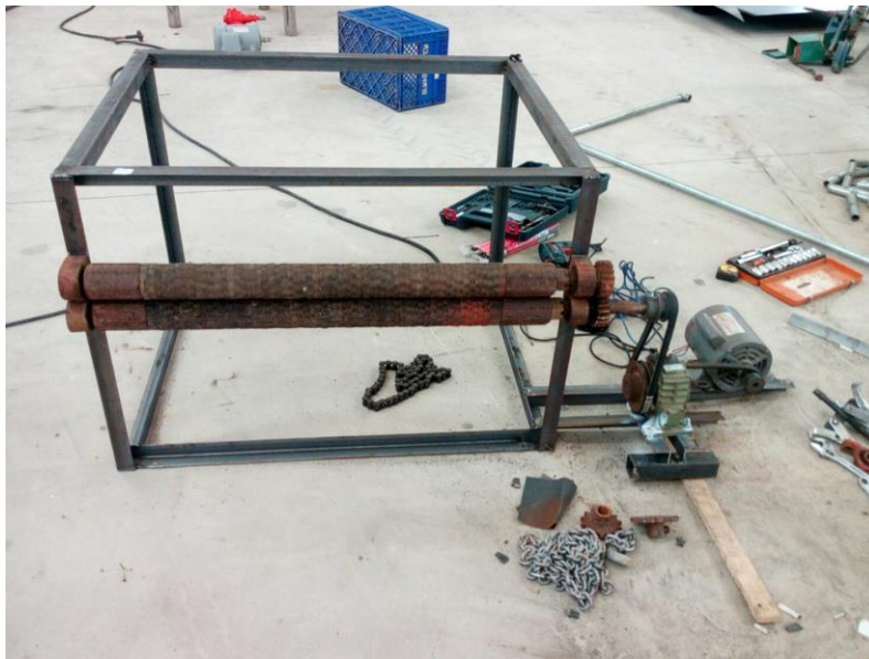
รูปที่12การสร้างแบบจำลองลูกกลิ้งผิวหยาบและการติดตั้งให้อยู่ในแนวตั้ง
