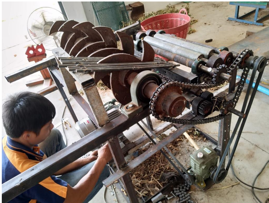
รูปที่18การทดสอบการปลิดแบบใช้จานปลิดแบบซี่ยาวร่องลึกหลายซี่ยาว
